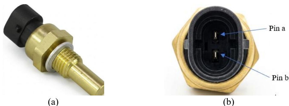
Fig. 6. Sensor de temperatura del motor – CHT, a) Imagen del sensor y b) Pines de conexión, Pin a: Alimentación, Pin b: Tierra.
