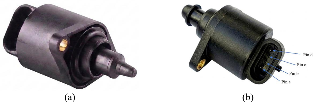
Fig. 7. Válvula de Control de Aire en Ralentí – IAC, a) Imagen del sensor y b) Pines de conexión, Pin a-Pin b: Bobinado 1, Pin c-Pin d: Bobinado 2.
