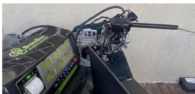
Fig. 34. Medición de emisiones del motor con inyección electrónica.
