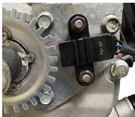
Fig. 23. Alineación e instalación del sensor CKP.
