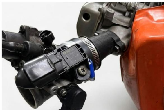
Fig. 22. Montaje definitivo del sistema de admisión al bloque del motor.
