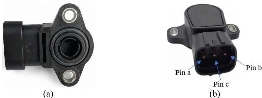
Fig. 8. Sensor de posición de la mariposa de aceleración – TPS, a) Imagen del sensor y b) Pines de conexión, Pin a: Alimentación, Pin b: Señal, Pin c: Tierra.
