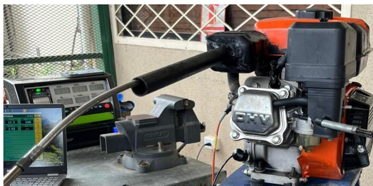
Fig. 19. Medición de emisiones del motor carburado.
