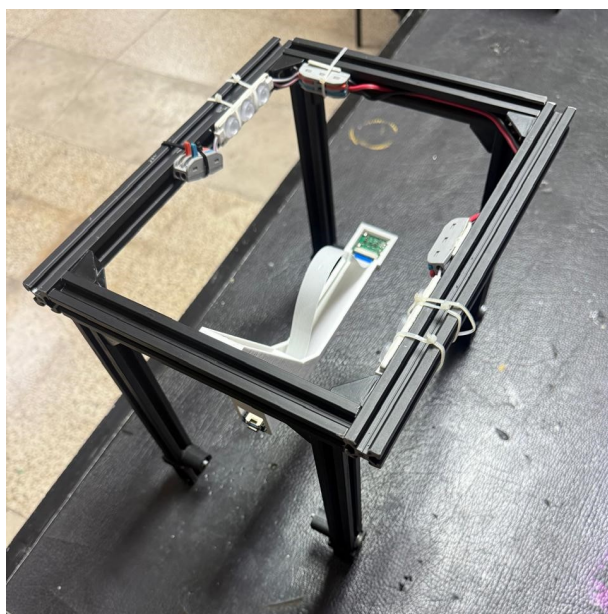
Figura 36: Perfiles de aluminio con cámara instalada.
