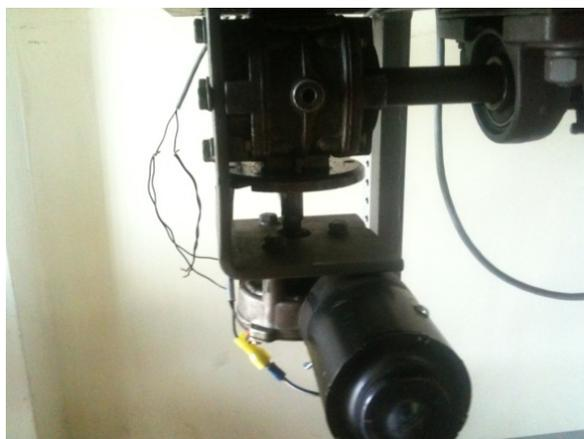
Gráfico 47: Acople entre el motor DC y la caja reductora.
