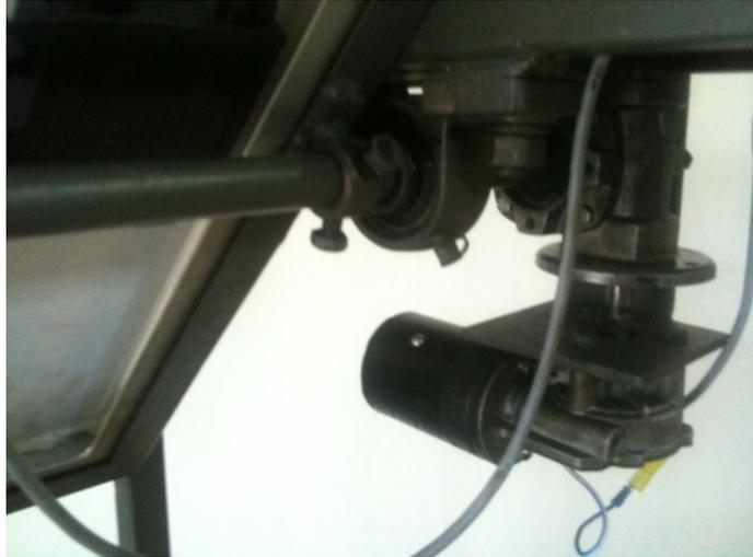
Gráfico 48: Acople del eje del panel solar y la base mediante chumaceras.
