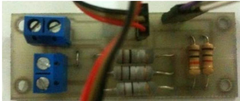
Gráfico 30: Módulo para medición de potencia.
