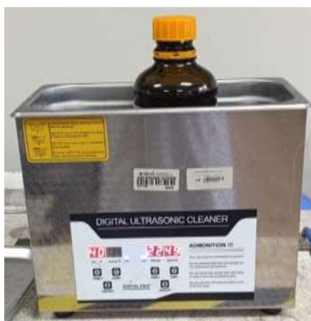
Figura 10. Extracto en baño ultrasónico.
