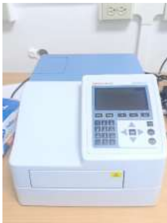
Figura 22. Equipo Multiskan™ FC 96 and 384-well Plate Microplate Photometers.
