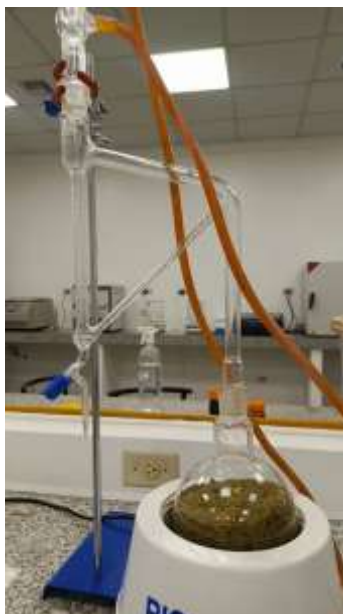
Figura 9. Equipo Clevenger utilizado para la obtención de aceite esencial.
