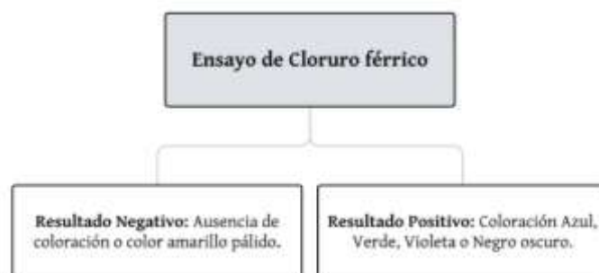
Figura 15. Representación esquemática de las reacciones colorimétricas obtenidas del ensayo de Cloruro férrico para la identificación de Fenoles.
