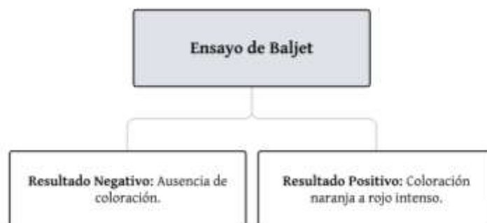
Figura 19. Representación esquemática de las reacciones colorimétricas obtenidas del ensayo de Baljet para la identificación de Lactonas sesquiterpénicas.
