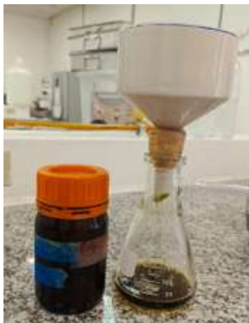
Figura 11. Filtración de los extractos acuosos, hidroalcohólico y alcohólico.
