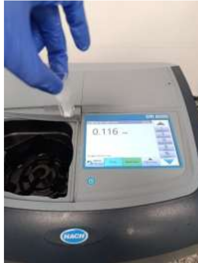
Figura 20. Absorbancia de la solución salina con E.coli constatando la escala McFarland.
