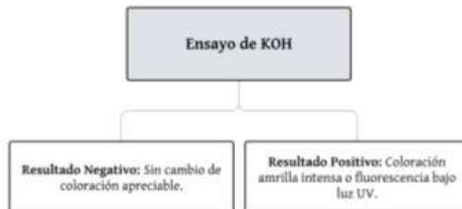
Figura 18. Representación esquemática de las reacciones colorimétricas obtenidas del ensayo de KOH para la identificación de Cumarinas.
