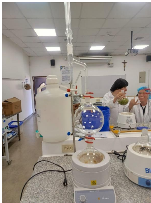
Figura 5. Equipo de hidrodestilación con trampa tipo Clevenger. Fuente: Autores, 2026.
