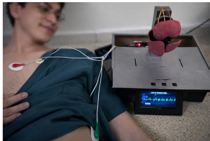
Figura 64: Prototipo en operación durante pruebas experimentales con usuario conectado al sistema ECG en tiempo real. Fuente: Autor propio.
