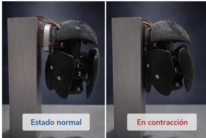
Figura 36: Contracción y relajación del corazón mecánico y señal real captada. Fuente: Autor Propio.
