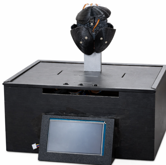
Figura 6: Simulador cardíaco original utilizado como base para el proceso de repotenciación [73].
