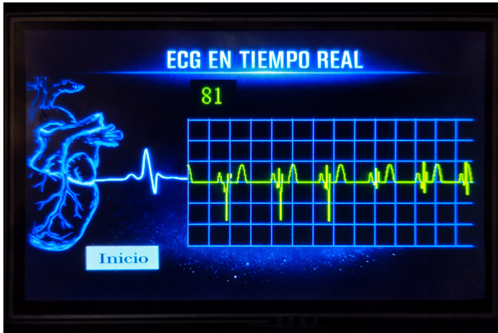
Figura 40: Interfaz gráfica en modo ECG en tiempo real mostrando el valor de BPM detectado y el trazado sincronizado. Fuente: Autor Propio.
