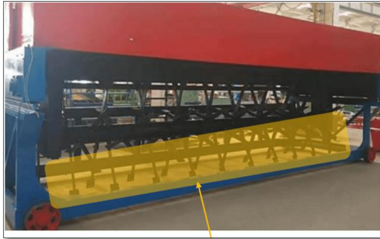
Figura 14. Rotor de eje horizontal con martillos o mayales [51].
