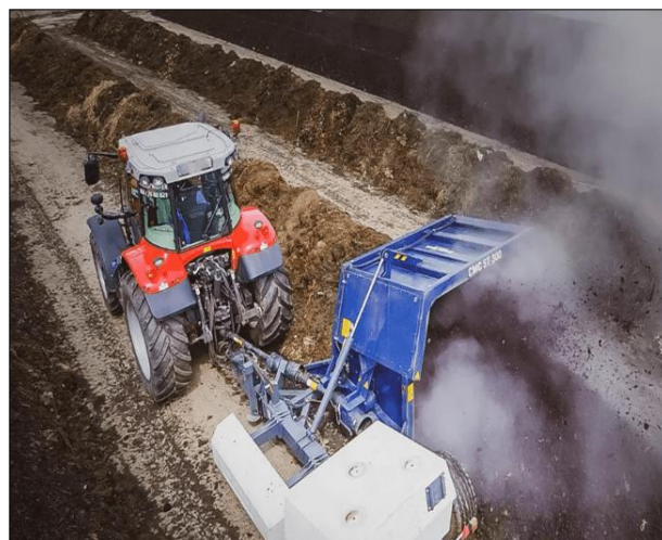
Figura 9. Volteadora de compost de arrastre acoplada a tractor [32].
