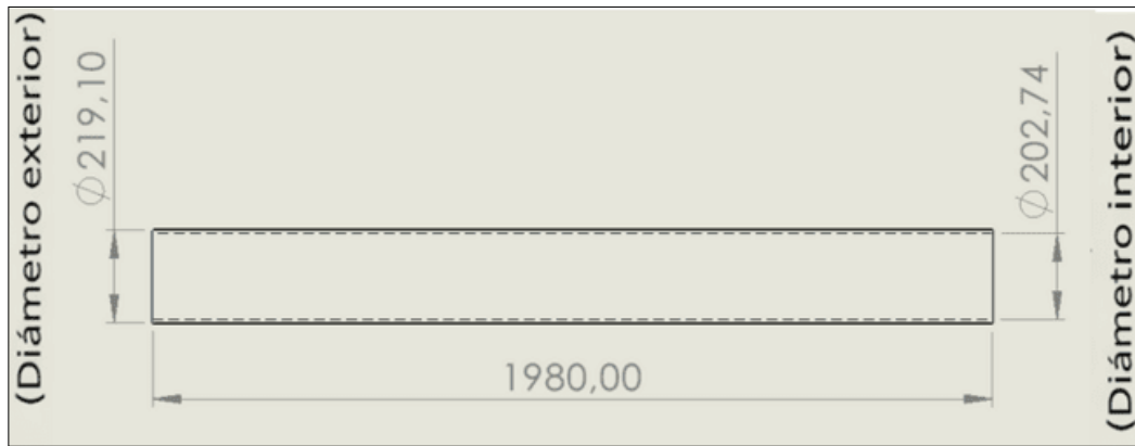
Figura 37. Dimensionamiento del tubo circular.
