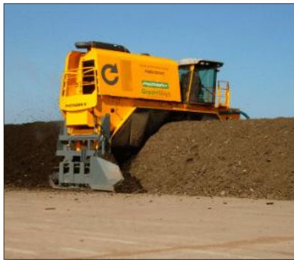
Figura 10. Volteadora de compost autopropulsada para aplicaciones de gran escala [33].
