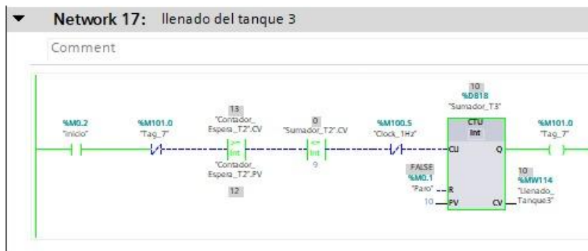
Figura 59 Llenado tanque T2
