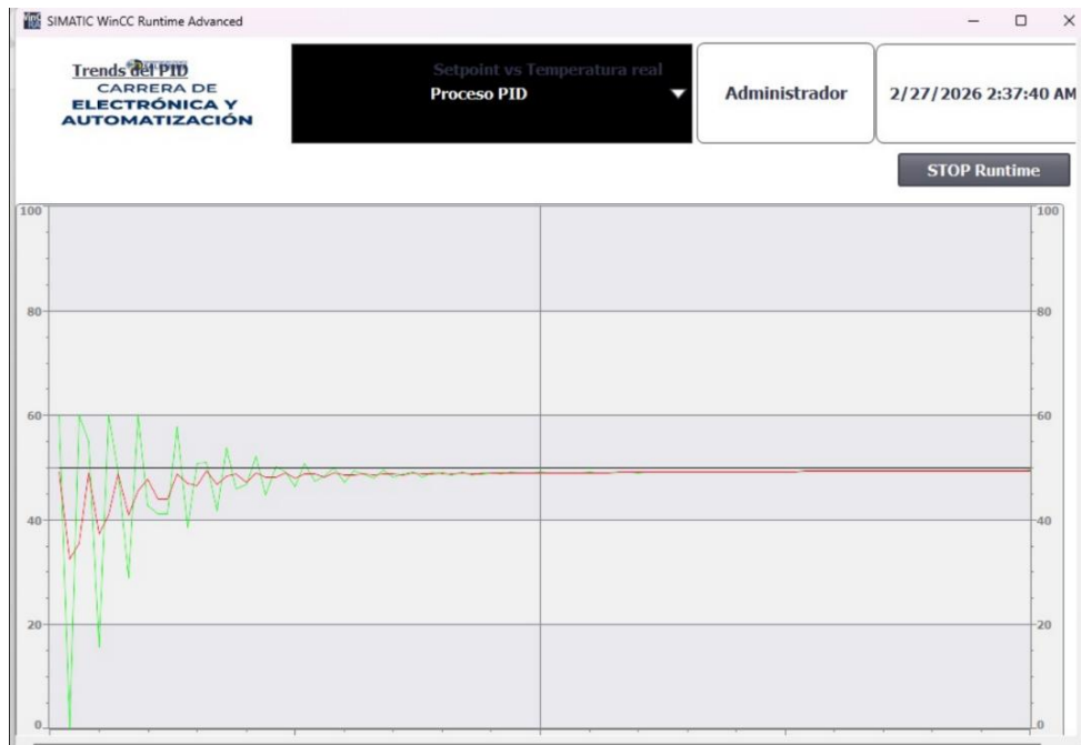
Figura 49 Tendencias del PID Setpoint vs Temperatura real
