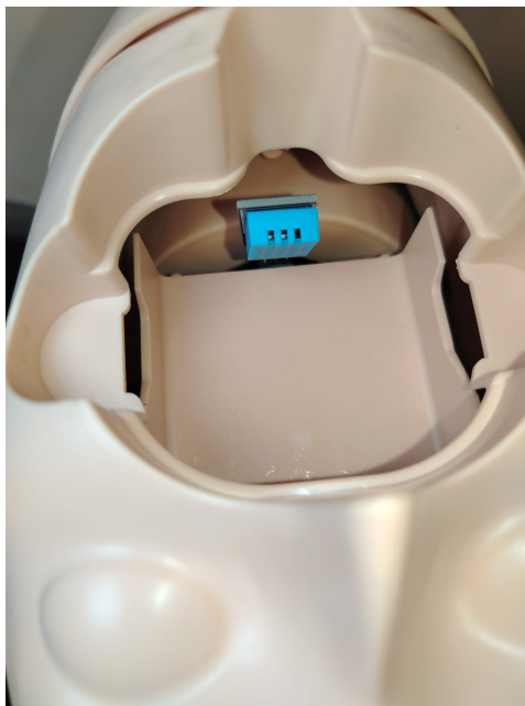
Figura 27: Ubicación e integración del sensor DHT11 en la cavidad bucal del simulador de RCP. Fuente: Autor Propio.
