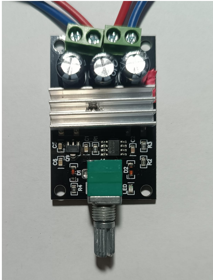
Figura 44. Modulador de ancho de pulso
