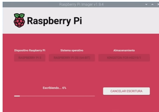
Figura 31. Instalación de sistema operativo en tarjeta MicroSD
