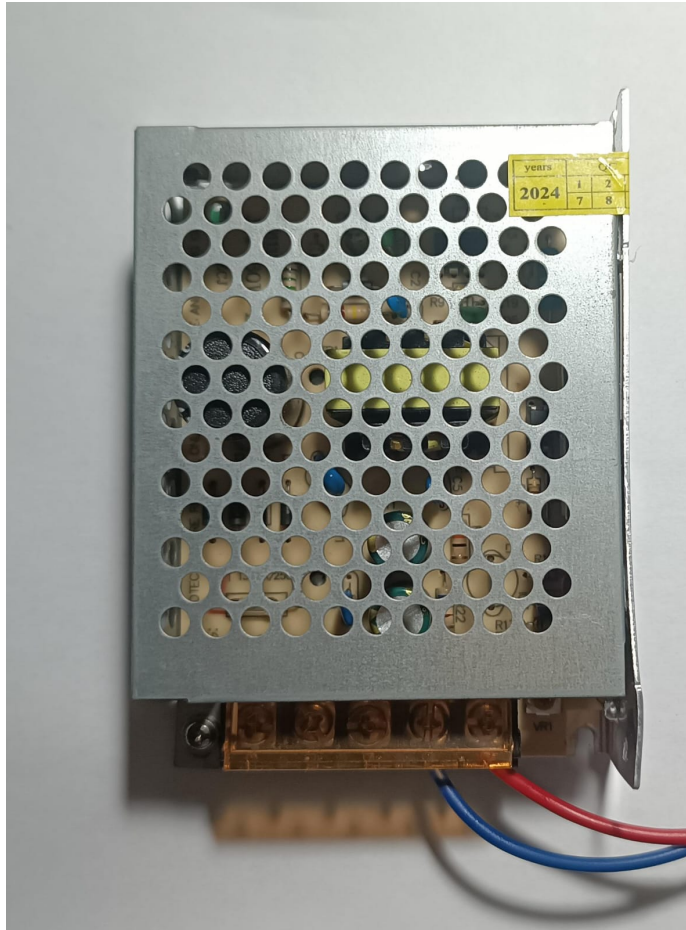
Figura 42. Fuente conmutada 5V
