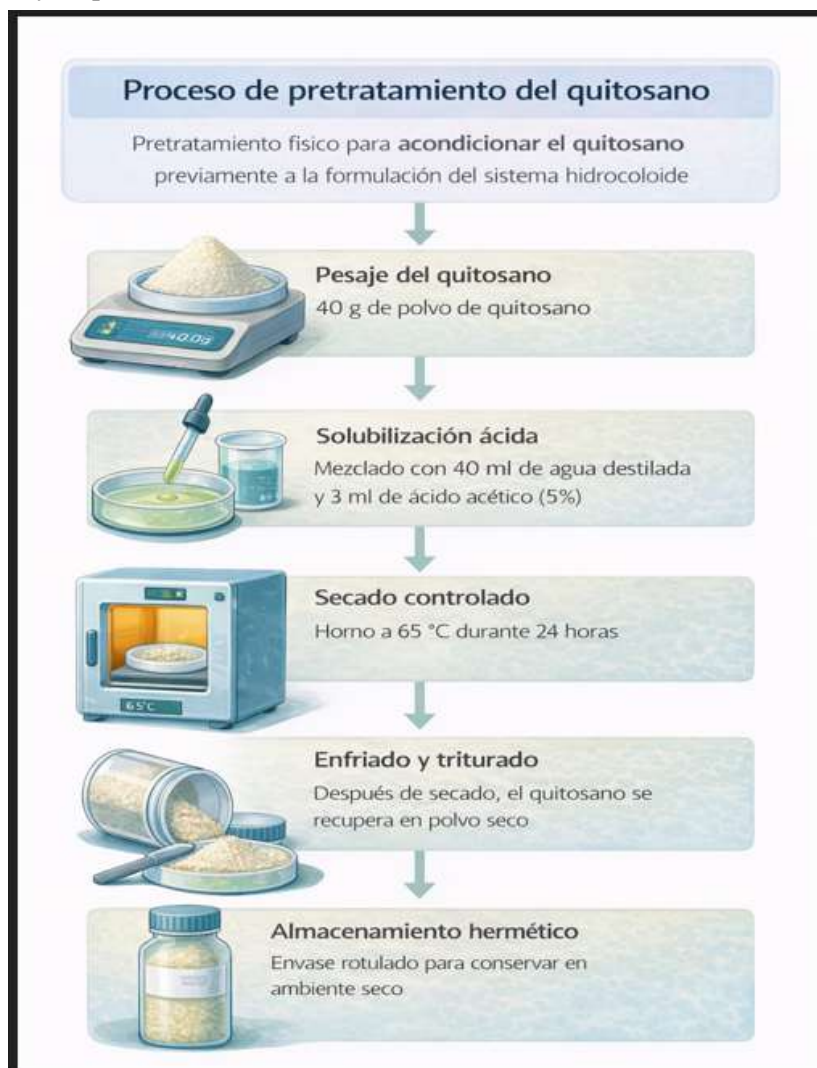
Figura 14: Esquema del procedimiento aplicado para el acondicionamiento previo del quitosano antes de su incorporación al sistema hidrocoloide, indicando las etapas destinadas a favorecer su solubilización y la formación de una matriz polimérica homogénea. [Autor propio]
