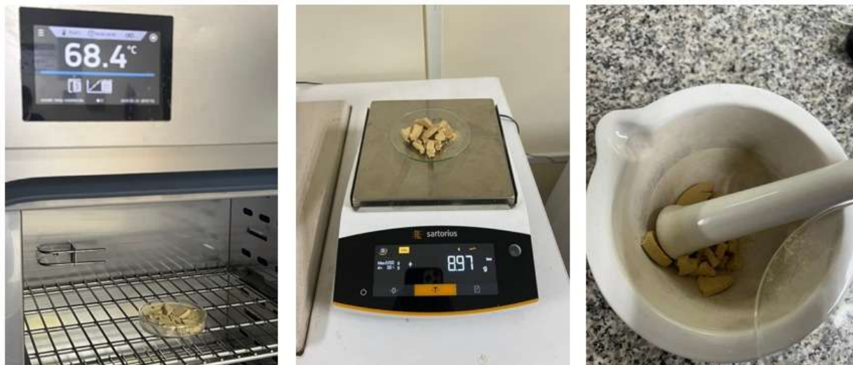
Figura 93: Secuencia experimental del pretratamiento del quitosano donde se muestra (izquierda) el acondicionamiento térmico controlado en estufa, (centro) la verificación gravimétrica del material mediante balanza analítica y (derecha) la trituración mecánica en mortero para reducir el tamaño de partícula y favorecer su posterior dispersión en el medio de formulación. [Autor propio]
