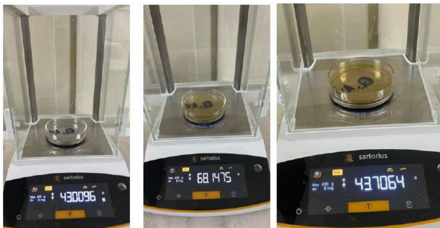
Figura 45: Registro del pesaje gravimétrico correspondiente a la formulación quitosano + aloe vera durante las tres etapas del procedimiento experimental, incluyendo el peso de la placa vacía, el peso de la placa con muestra antes del secado y el peso de la placa con muestra después del secado. [Autor propio]
