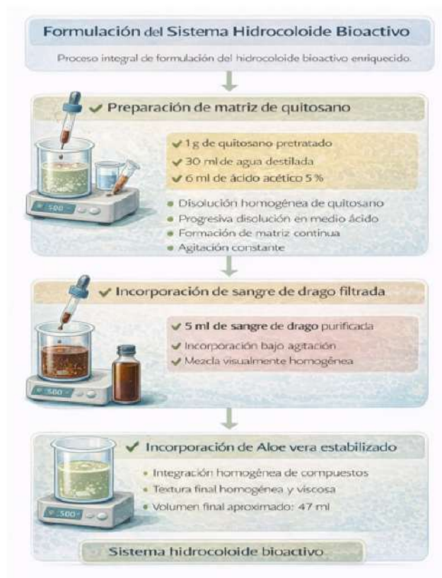
Figura 18: Diagrama del proceso de formulación del sistema hidrocoloide que integra los componentes estructurales y bioactivos, mostrando la secuencia de incorporación y las etapas clave necesarias para la obtención de la matriz final. [Autor propio]
