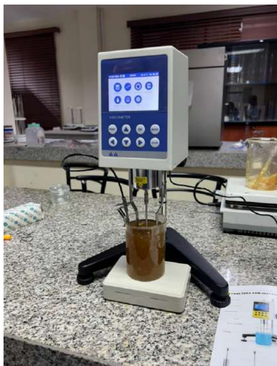
Figura 94: Viscosímetro rotacional empleado en las pruebas de caracterización. [Autor propio]
