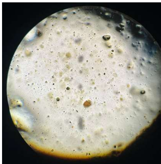
Figura 39: Película de quitosano pretratado observada bajo microscopía. [Autor propio]
