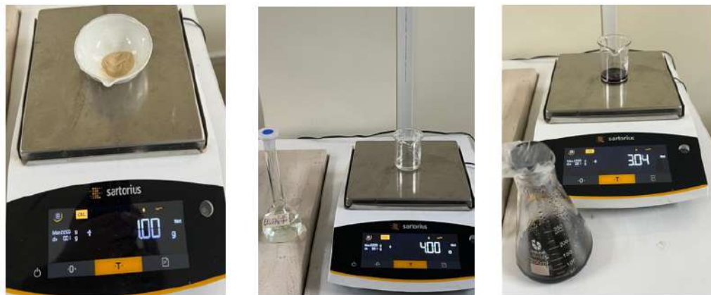
Figura 16: Registro del pesaje individual de los tres componentes, principales del sistema hidrocoloide: Quitosano (izquierda), Aloe Vera estabilizado con 4ml de EDTA (centro), Sangre de drago (derecha) previo a su formulación. [Autor propio]
