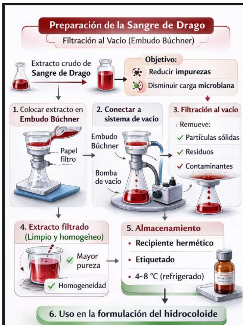
Figura 15: Representación secuencial del procedimiento aplicado para la preparación y acondicionamiento del extracto de sangre de drago previo a su incorporación en la formulación del sistema hidrocoloide. [Autor propio]
