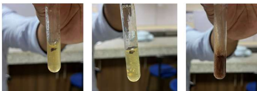
Figura 26: Disposición de los tubos de ensayo que contienen las muestras del sistema hidrocoloide destinadas al análisis de sinéresis, Q(izquierda), Q+AV(centro), Q+AV+SD(derecha), preparadas bajo condiciones controladas para evaluar la liberación de fase líquida y la estabilidad estructural del material formulado. [Autor propio]
