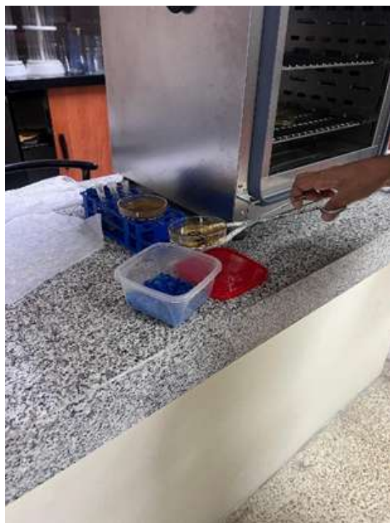
Figura 25: Montaje experimental que muestra el uso de sílica gel como agente desecante durante el ensayo de retención de humedad del sistema hidrocoloide, empleado para generar un ambiente controlado de baja humedad y evaluar la capacidad del material para conservar su contenido hídrico bajo condiciones de desecación. [Autor propio]
