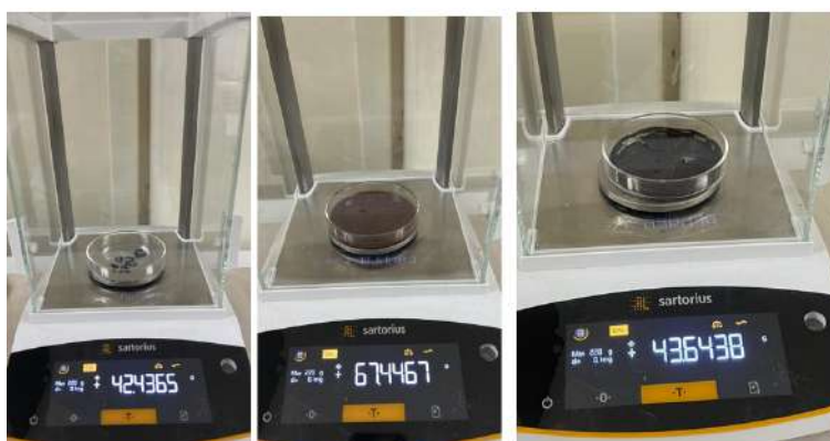
Figura 46: Registro del pesaje gravimétrico correspondiente al sistema hidrocoloide completo durante las tres etapas del procedimiento experimental, incluyendo la medición del peso de la placa vacía, el peso de la placa con muestra antes del secado y el peso de la placa con muestra después del secado. [Autor propio]
