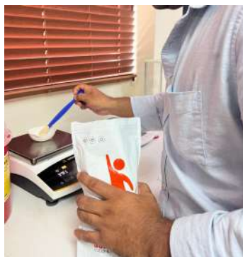
Figura 9: Proceso de dosificación y pesado del quitosano durante la etapa de preparación experimental. [Autor propio]
