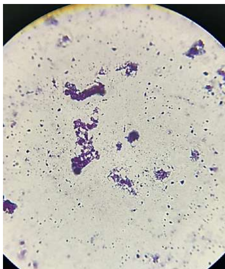
Figura 50: Evaluación microscópica de la formulación M2 (quitosano + 5 mL de sangre de drago) en contacto con suspensión bacteriana. [Autor propio]
