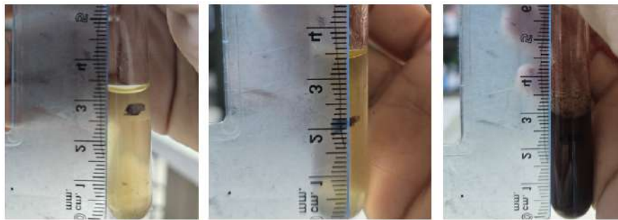
Figura 47: Resultados obtenidos del ensayo de sinéresis en las muestras del sistema hidrocoloide, donde se observa la presencia o ausencia de liberación de fase líquida como indicador de estabilidad estructural y capacidad de retención hídrica del material formulado. [Autor propio]
