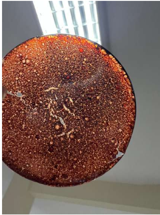
Figura 95: Detalle de la porosidad superficial observada en la película formada a partir del sistema hidrocoloide, donde se aprecian microestructuras irregulares asociadas al proceso de secado y a la organización interna de la matriz polimérica, características que influyen en la retención hídrica y en la difusión de compuestos bioactivos. [Autor propio]
