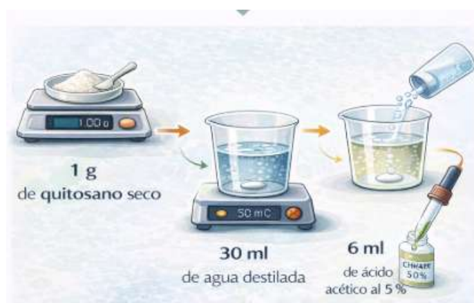
Figura 10: Representación gráfica del proceso de acidificación de quitosano sin pretratamiento. [Autor propio]
