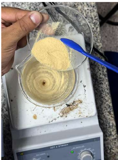
Figura 24: Proceso de preparación de la formulación base del sistema hidrocoloide mediante agitación magnética controlada, empleado para favorecer la dispersión homogénea del quitosano en el medio acidificado y promover la formación inicial de la red polimérica estructural. [Autor propio]
