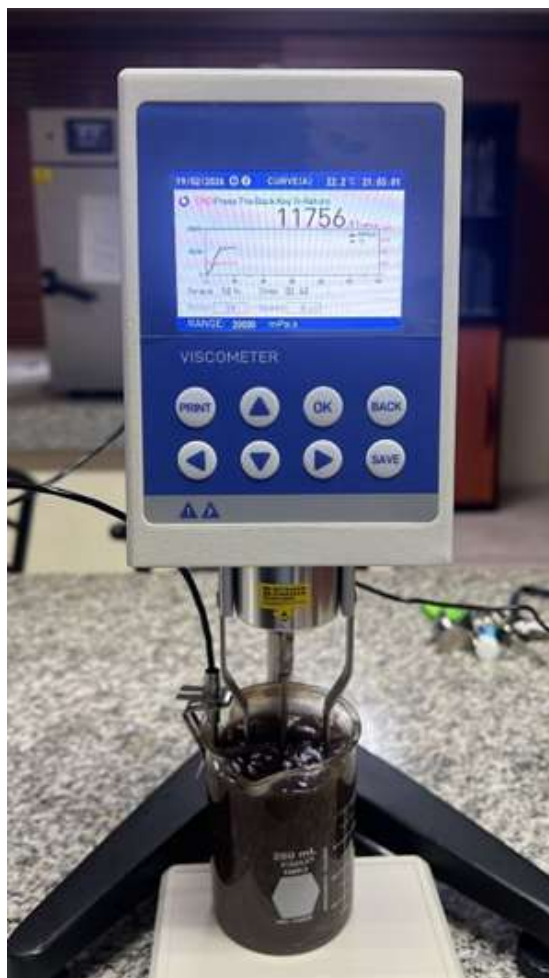
Figura 43: Perfil reológico correspondiente a la muestra 3 del sistema hidrocoloide formulado (quitosano + aloe vera + sangre de drago), obtenido mediante medición viscosimétrica rotacional. [Autor propio]
