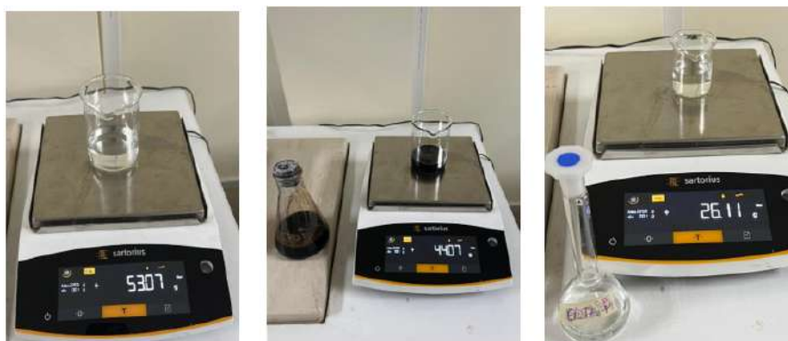
Figura 23: Registro visual de las cantidades medidas de los componentes líquidos utilizados durante la formulación del sistema hidrocoloide: ácido acético 5 %, sangre de drago y aloe vera estabilizado con EDTA, preparados previamente para su incorporación controlada en la matriz polimérica. [Autor propio]
