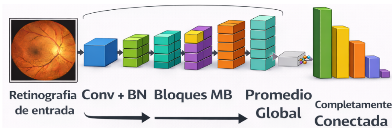
Figura 15. Diagrama de la arquitectura EfficientNet-B0 aplicada al análisis de retinografías para la clasificación multietapa de RD. Fuente: Autor Propio.
