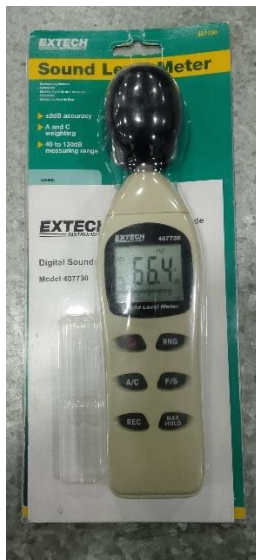
Ilustración 2 - Sonómetro digital Extech, modelo 407730, utilizado para la medición de niveles de presión sonora en dB(A).
