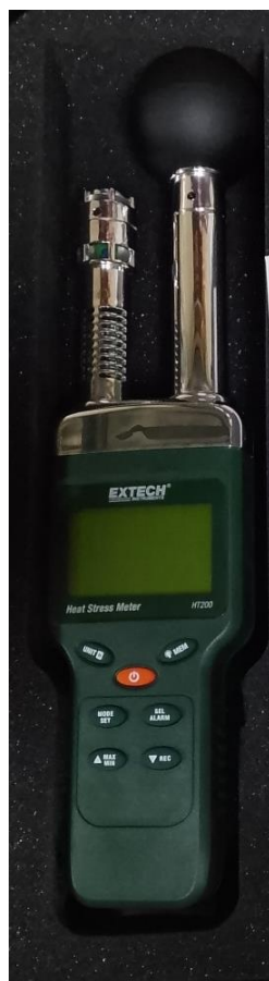
Ilustración 4 - Termohigrómetro digital Extech, modelo HT200, utilizado para la medición de temperatura ambiente y humedad relativa.
