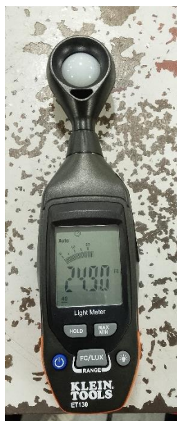
Ilustración 3 - Luxómetro digital Klein Tools, modelo ET130, empleado para la medición de los niveles de iluminación en lux.
