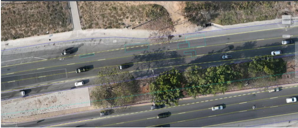
Ilustración 11: Delimitaciones de fallas sobre ortomosaico para registro de áreas.
