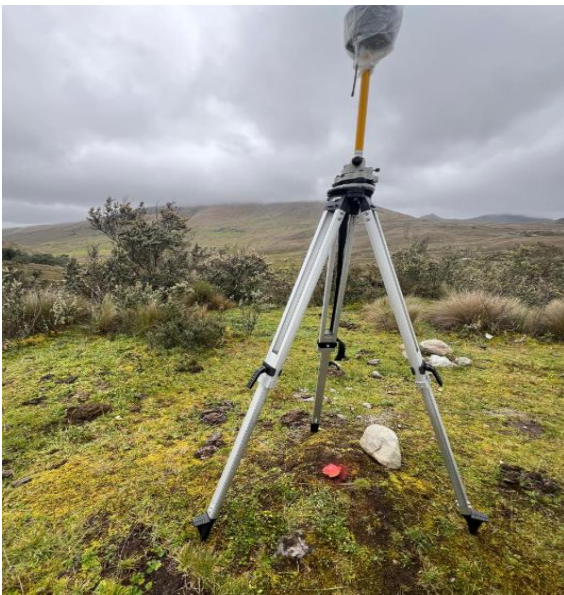
Ilustración 24. Punto de control para la antena RTK
