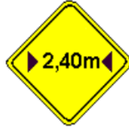
Ilustración 17. Señalización de anchos máximos.
