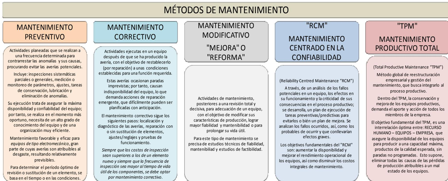
Figura 1.4: Métodos de mantenimiento. Fuente: TAVARES, Lourival A., Administración moderna del mantenimiento, 2003; GARCÍA GARRIDO, Santiago, Ingeniería del mantenimiento, 2009.
