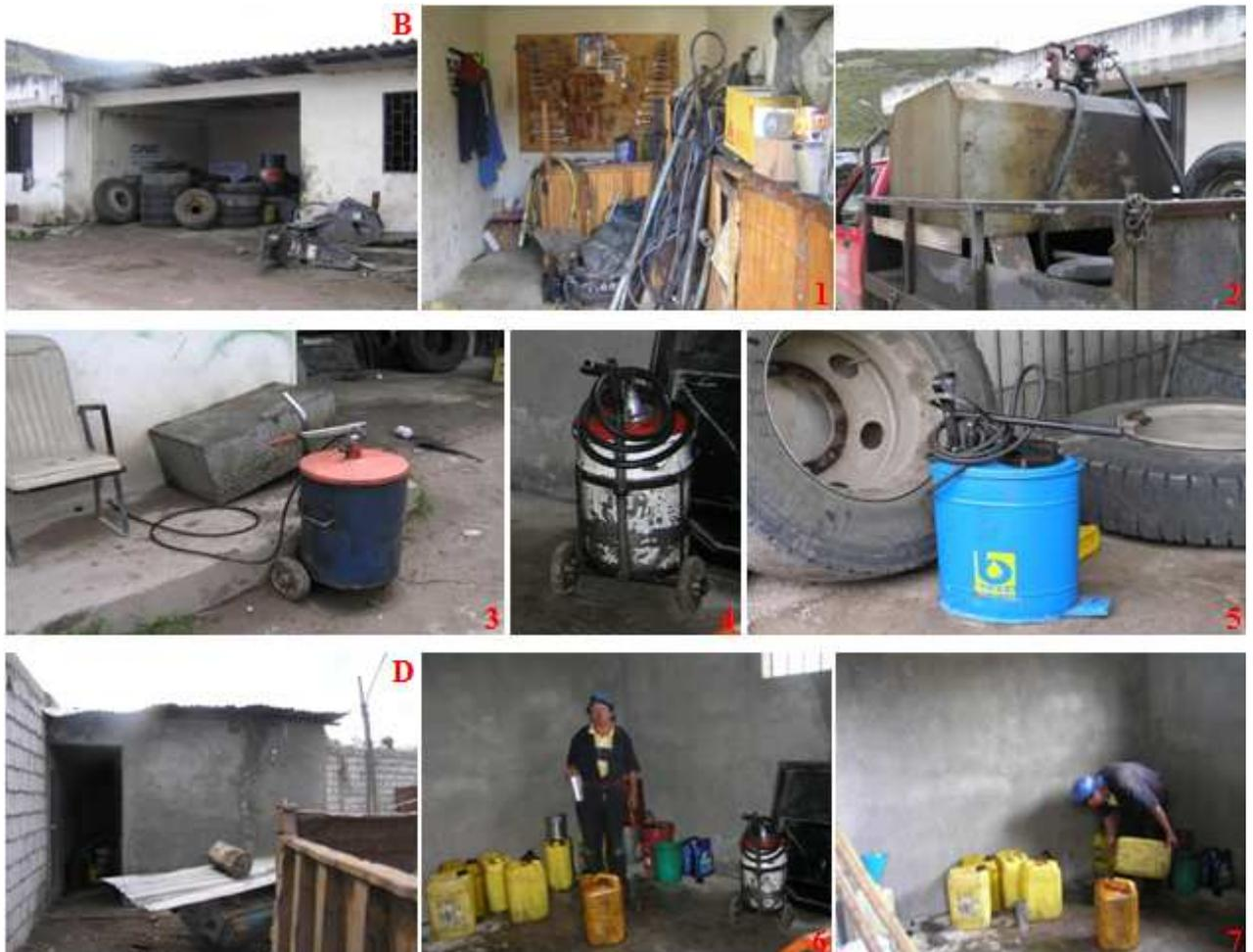
Figura 2.19: **B.** Galpón para neumáticos en uso, accesorios/aperos de maquinarias y bodega de herramientas, 1. Interior de la bodega con herramienta básica, 2. Tanque bomba para abastecimiento de diesel, 3-4. Graseros, 5. Bomba de lubricación, **D.** Bodega para lubricantes, 6-7. Interior de la bodega para lubricantes al granel. Fuente: Autor.
