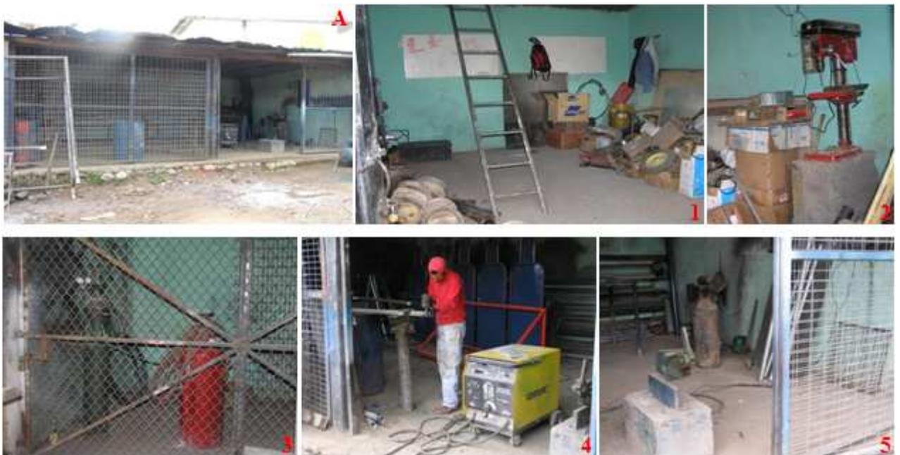
Figura 2.20: A. Taller de mecánica industrial incluido una bodega para sus herramientas, 1. Interior de la bodega para mecánica industrial con herramienta básica, 2. Taladro de pedestal, 3. Equipo de suelda oxi-acetilénica, 4. Equipo de suelda eléctrica y entenalla, 5. Esmeril y cizalla. Fuente: Autor.
