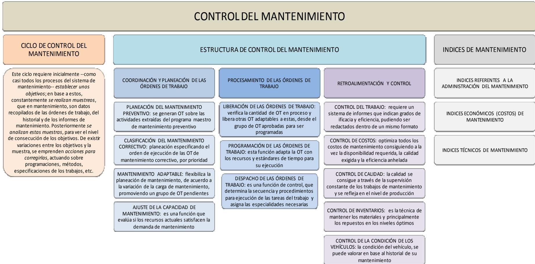
Figura 1.22: Control del mantenimiento. Fuente: DUFFUAA, Salih y otros, Sistemas de mantenimiento “Planeación y Control”, 2000.
