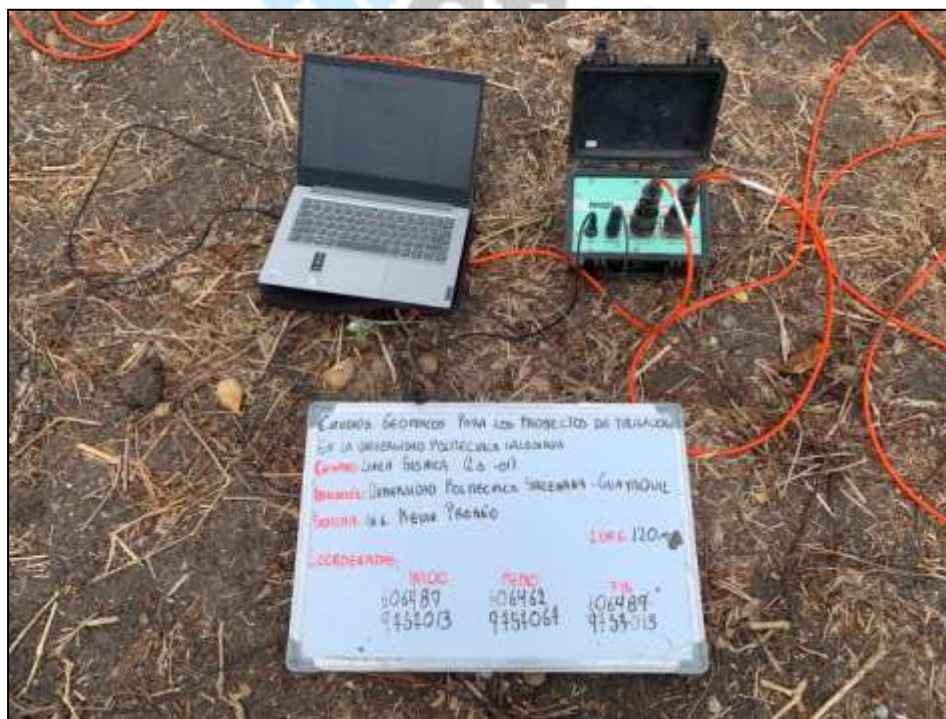
Fotografía 3: Equipo utilizado para el ensayo de Sísmica MAS W. Fuente: Consultor
