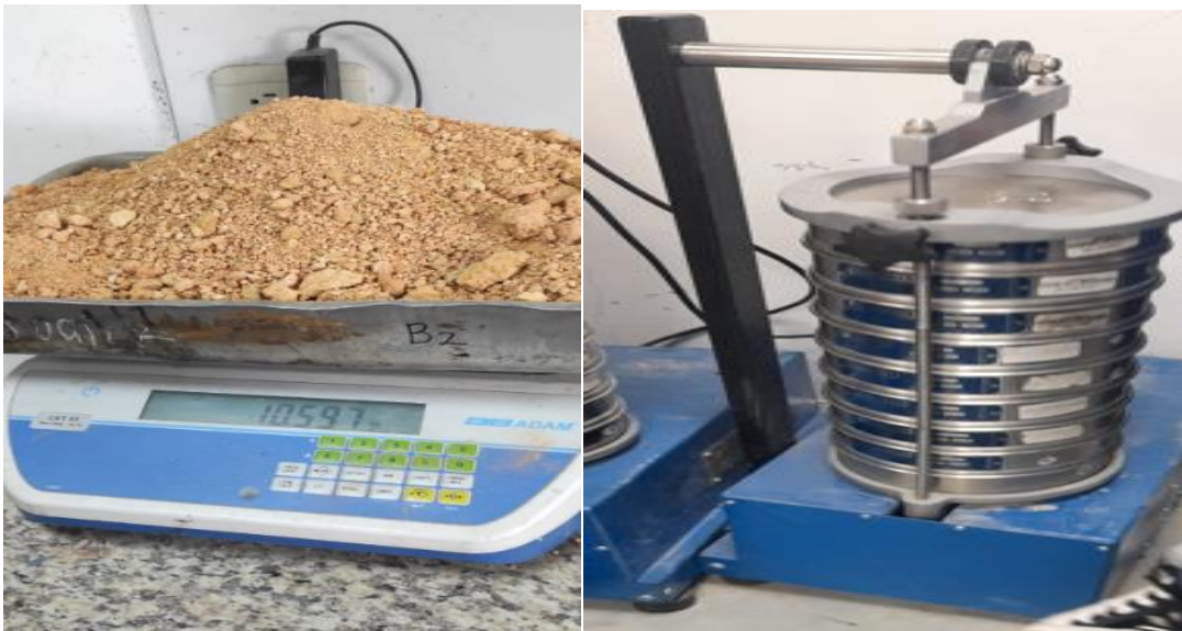
Ilustración 38: Ensayo de Granulometría
