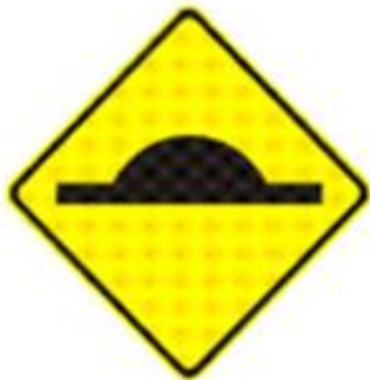
Ilustración 29: Señalización vertical, Reductor de velocidad (P6-2)
