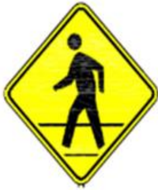
Ilustración 28: Señalización vertical, Peatones en la vía (P6-1)
