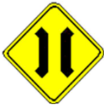
Ilustración 27: Señalización vertical, Puente angosto (R4-1)
