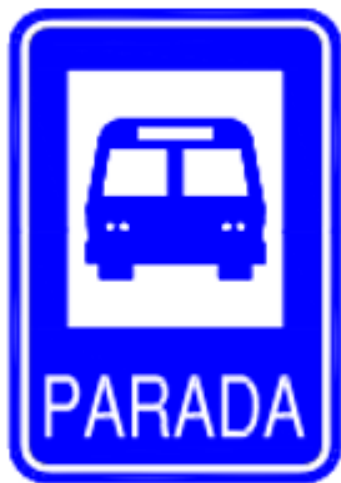
Ilustración 24: Señalización vertical, Parada de bus (R5-6)
