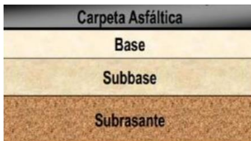
Ilustración 11: Estructura Típica de un Pavimento Flexible
