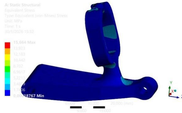
Ilustración 36 Esfuerzo equivalente del brazo inferior
