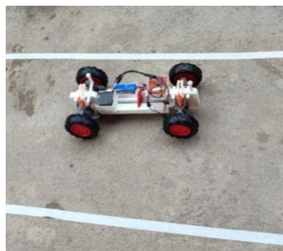
Ilustración 10 Vehículo sin carrocería para evidenciar el funcionamiento de la dirección
