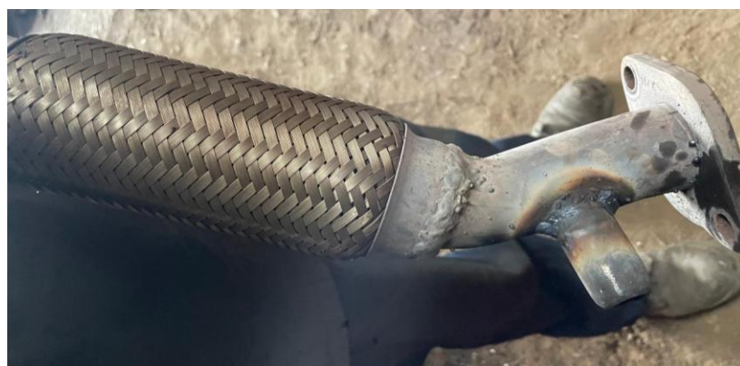
Figura 27. Soldadura de acople para sensor EMP
