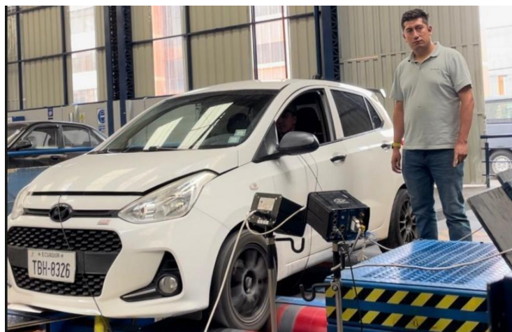
Figura 94. Prueba de potencia en banco con ingeniero encargado
