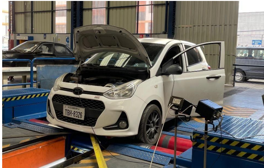
Nota. Prueba en banco con escape original (Autor)
