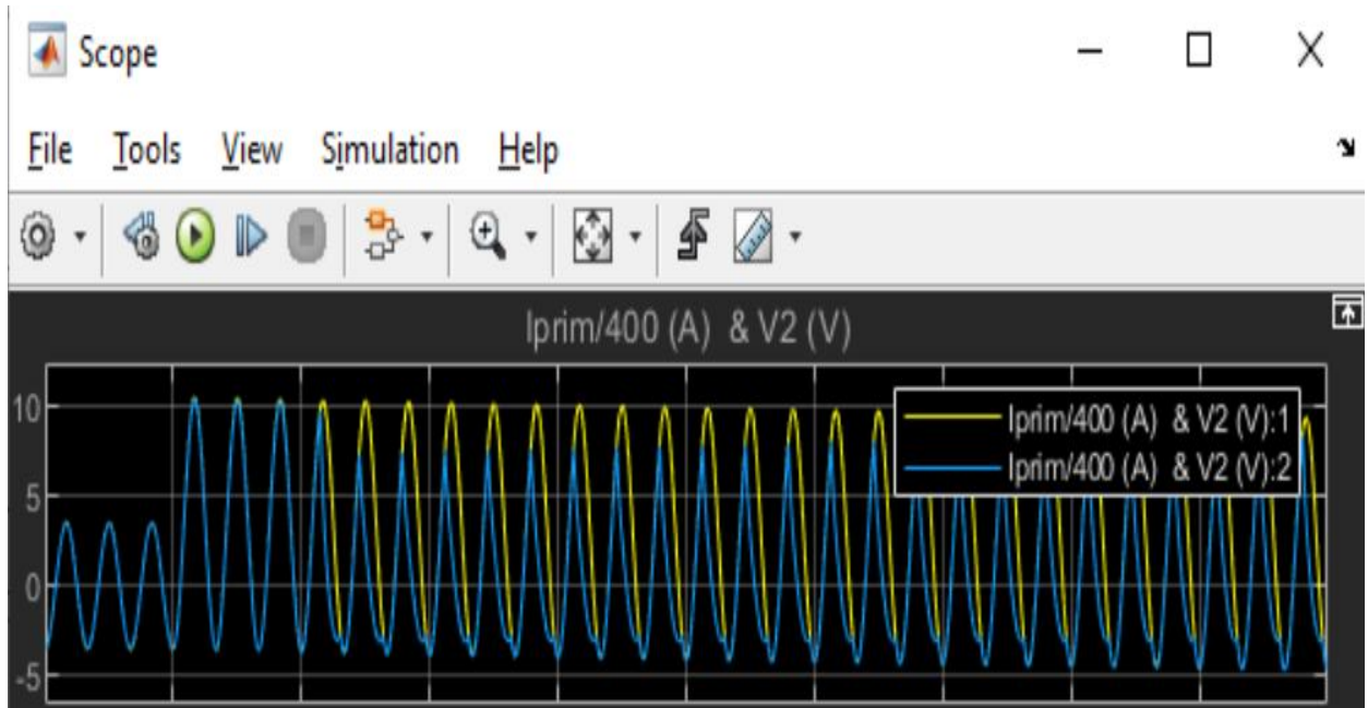
Figura 32. Comportamiento de durante la Saturación magnética del Núcleo TC.
