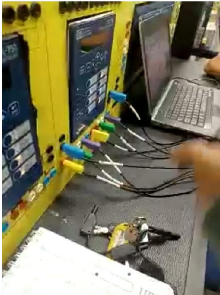
Figura 43. Conexión de la maleta ómicron Función medición Analógica a la Computadora.
