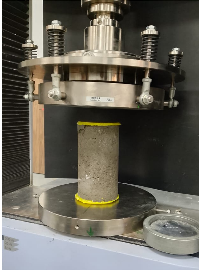
Cilindros con base Capping de Azufre
