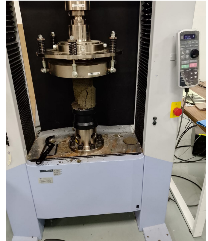
Ruptura de cilindro
