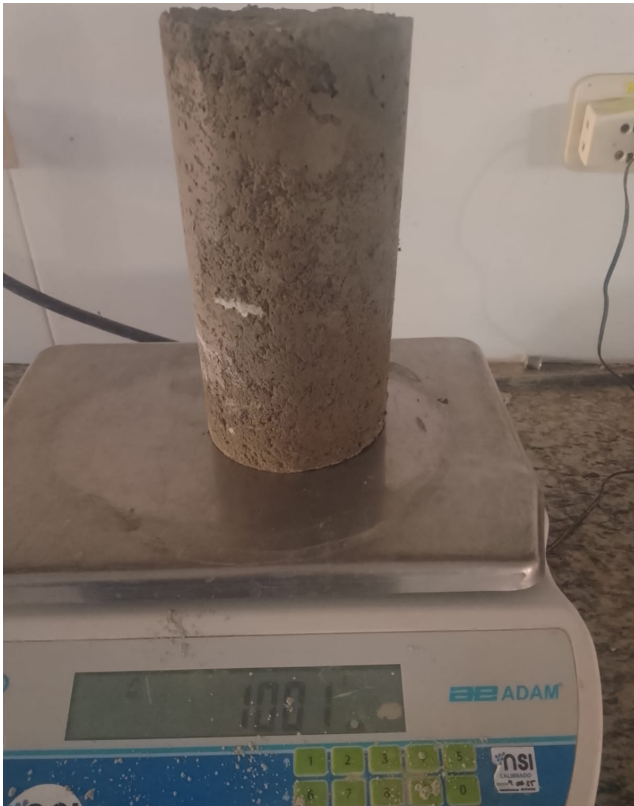
Verificación de peso de cilindro
