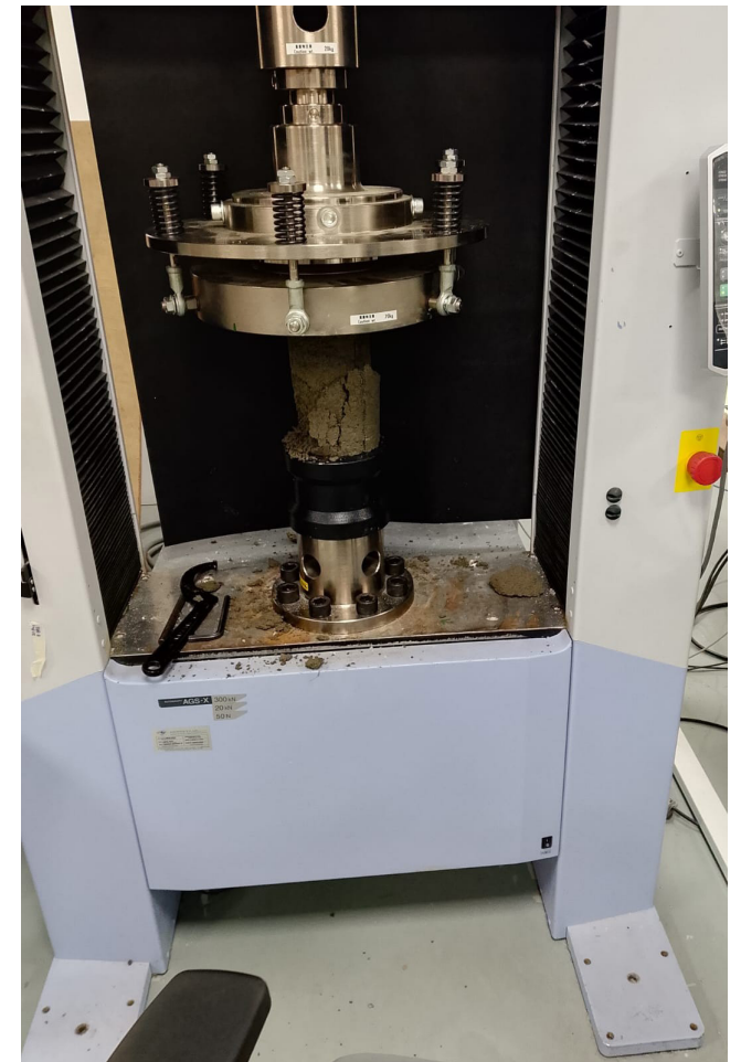
Rotura de cilindros
