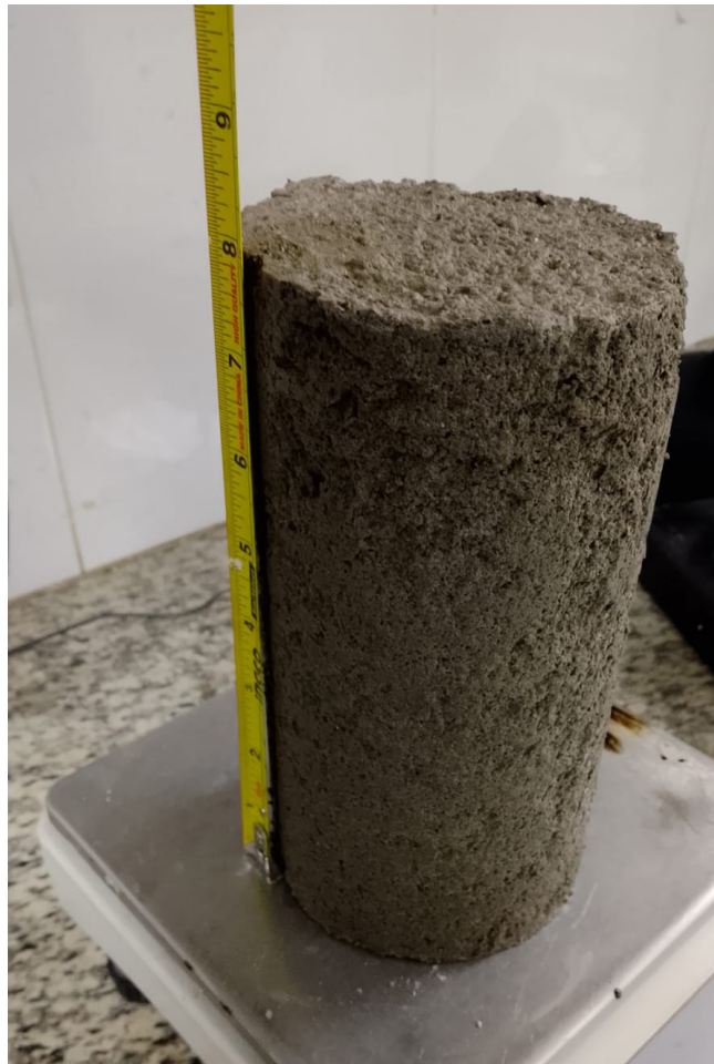
Verificación de altura de cilindro para ensayo
