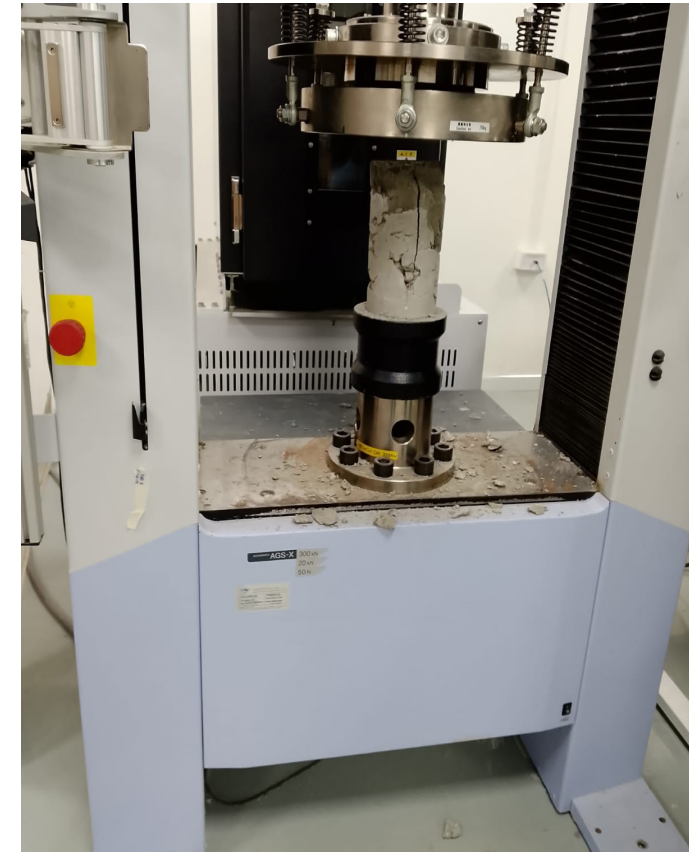
Ruptura de cilindro
