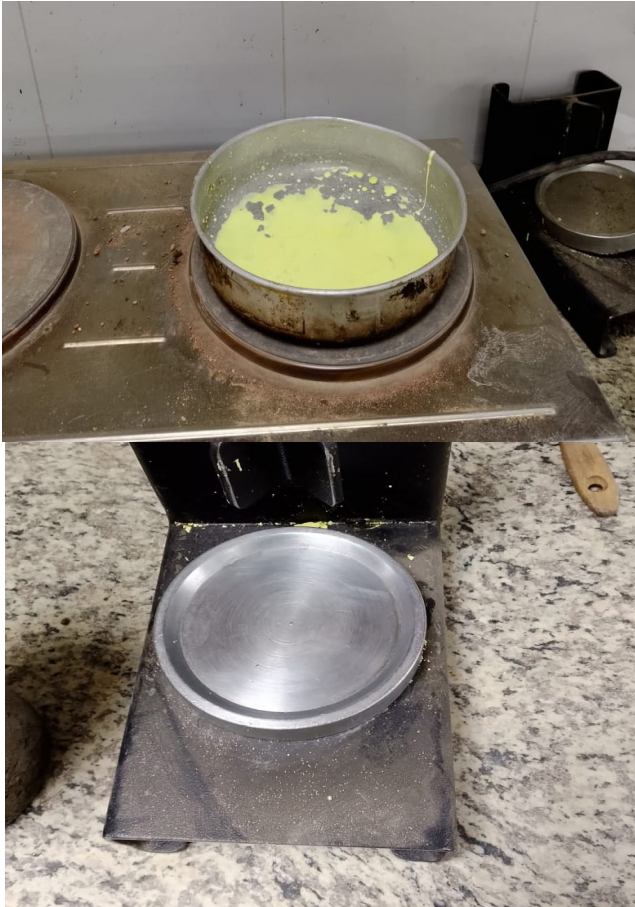
Utilización de capping con azufre para pruebas de resistencias
