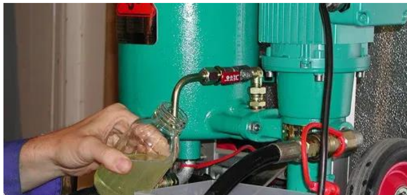
Figura 3. Extracción de muestra de aceite lubricante [15].
