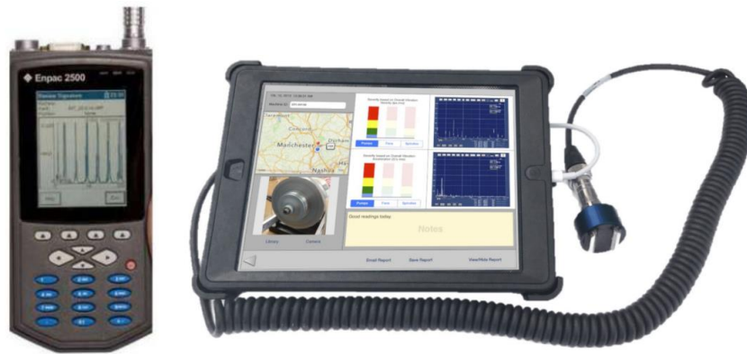
Figura 2. Analizador de vibraciones [13], [14].
