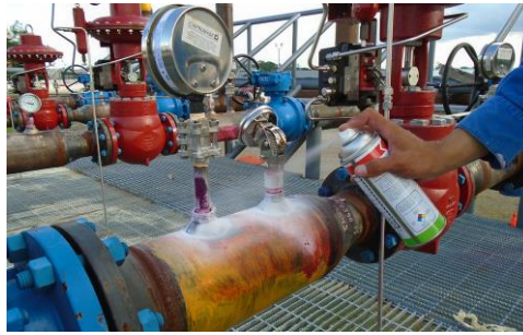
Figura 7. Aplicación de líquido penetrante [18].
