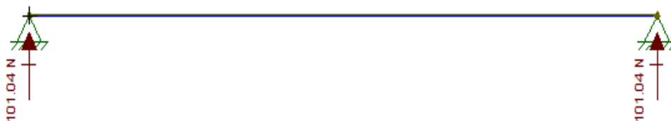
Figura 21. Cargas del eje mezclador.
