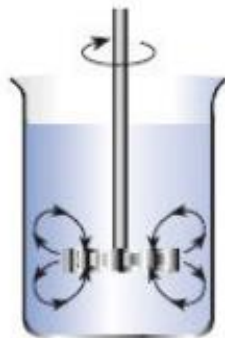
Figura 5. Agitador turbina (flujo radial) [20].
