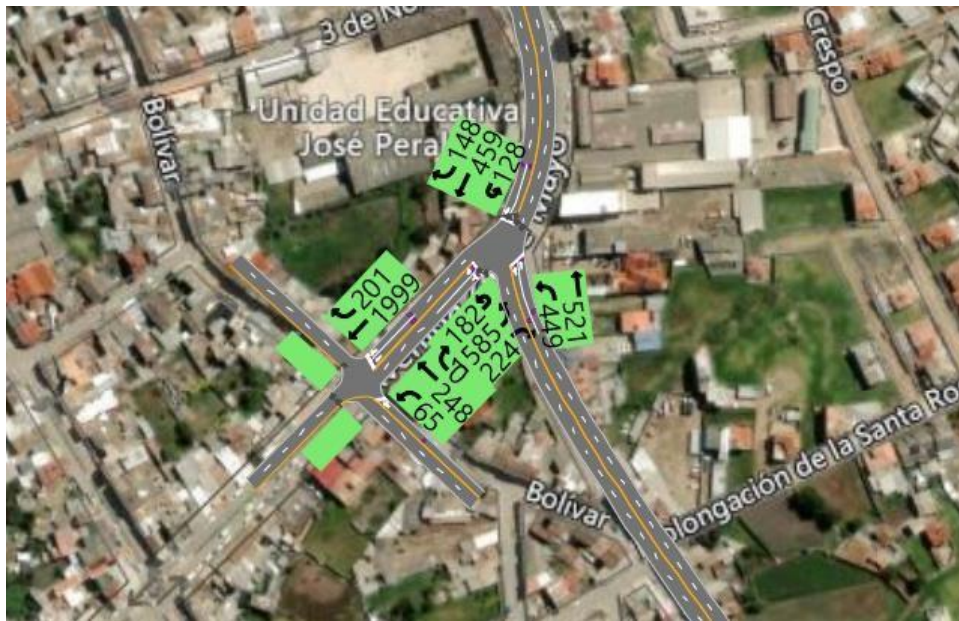
Figura 32. Modelación de la solución proyectada para el 2045
