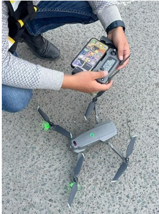
Figura 14. levantamiento con el dron DJI Mavic 2 Zoom.
