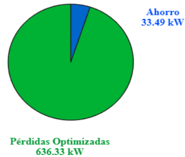
Figura 13. Comparación de pérdidas y ahorro, del sistema eléctrico IEEE 30 barras (FA).
