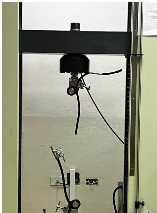
Figura 17: Fractura de conductor de Aluminio (Al)
