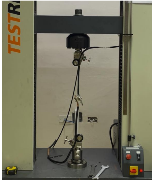
Figura 16: Cedencia de conductor de Cobre (Cu)
