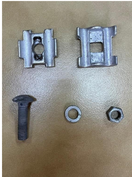
Figura 19: Conector ranura paralela después de la fractura del conductor de Aluminio (Al)
