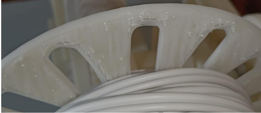
Figura 75. Porosidades en el carrete del sistema.
