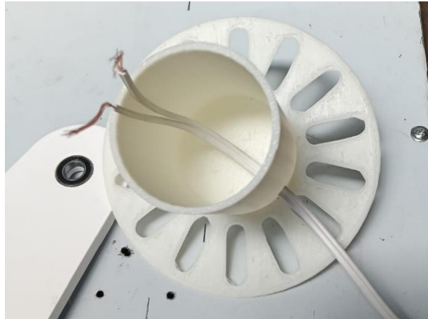
Figura 56. Cable insertado dentro del carrete.
