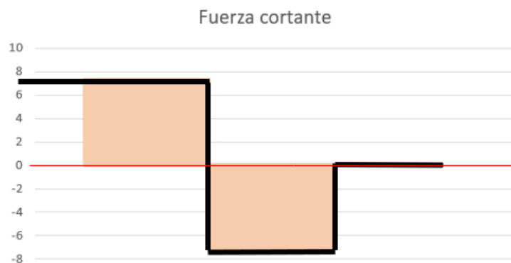
Figura 23. Fuerza cortante en el eje.
