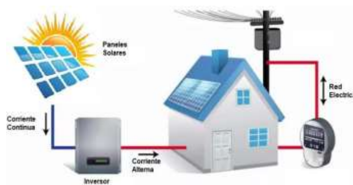
Figura 9. Sistema fotovoltaico On Grid
