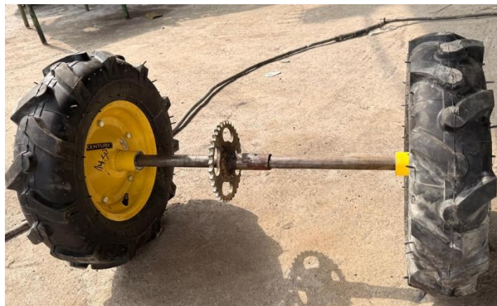
Figura 4. Sistema tracción del motocultor.
