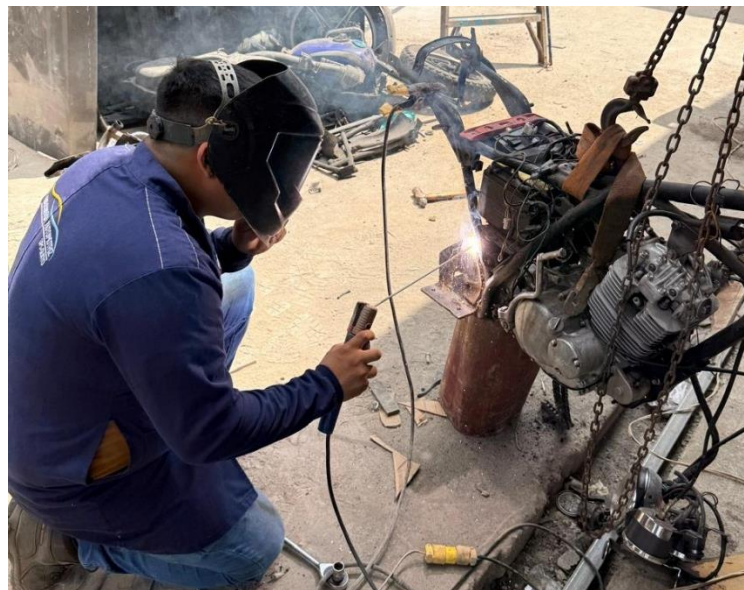
Figura 11. Soldando nuevo soporte para los ejes.
