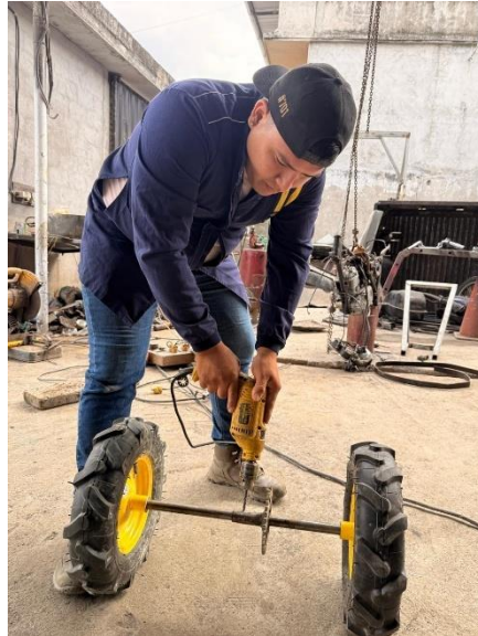
Figura 12. Ensamble de eje y neumáticos de tracción.
