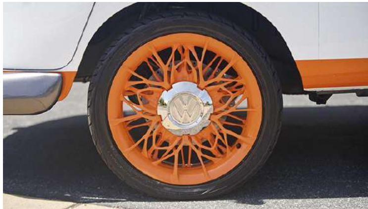
Figura 13. Llanta fabricada con impresión 3D, Volkswagen Type 20 [41].
