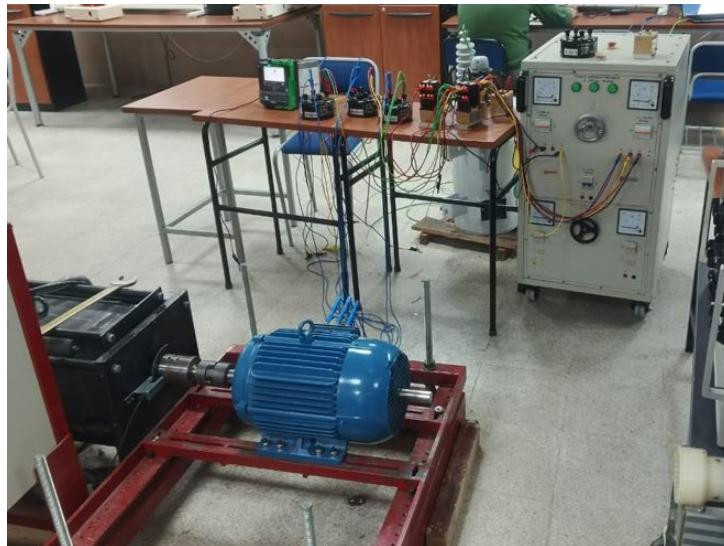
Figura 3.7: Montaje del sistema de protección para la validación de la función 59
