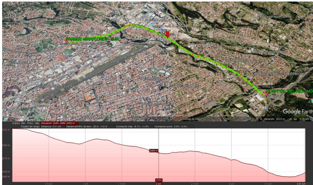
Figura 81. Elevación, pendiente, tramos marcados cada 100m
