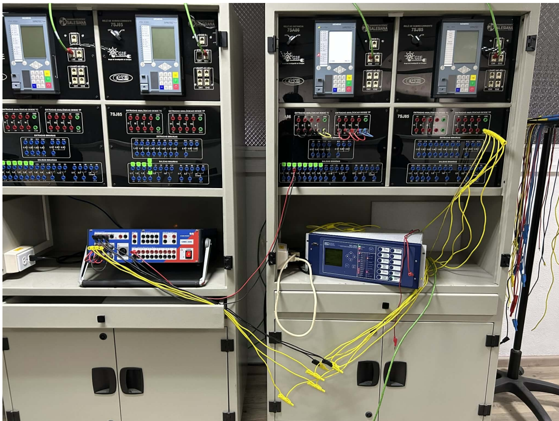
Figura 5.8: Escenario 2 – Intertipping SEL-411L hacia Siemens 7SA86.
