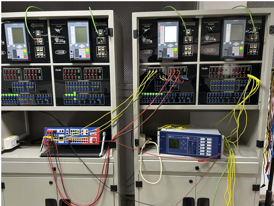
Figura 5.7: Escenario 1 – Intertripping Siemens 7SA86 hacia SEL-411L en Zona 1.
