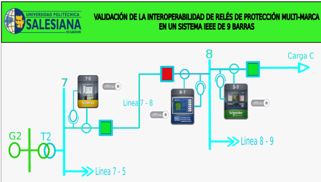
Figura 2.2: Localización de los IEDs en el sistema IEEE de 9 barras.
