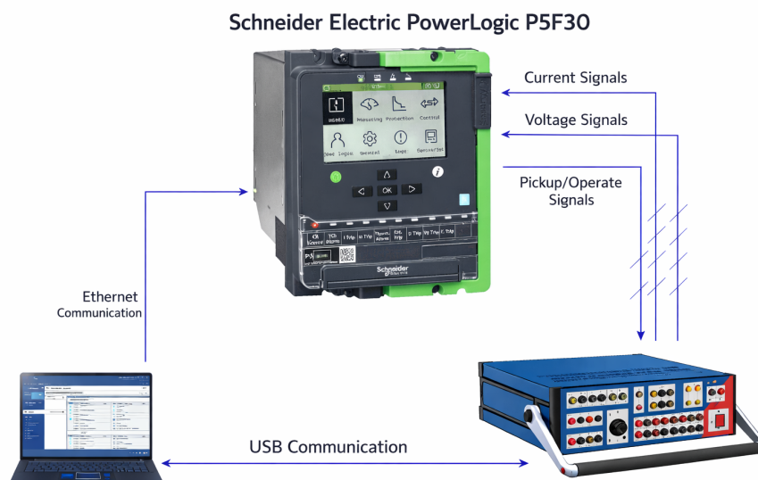
Figura 3.3: Esquema de conexión para ensayos del relé Schneider PowerLogic P5F30 mediante Easergy Pro (eSetup) y OMICRON CMC 356.
