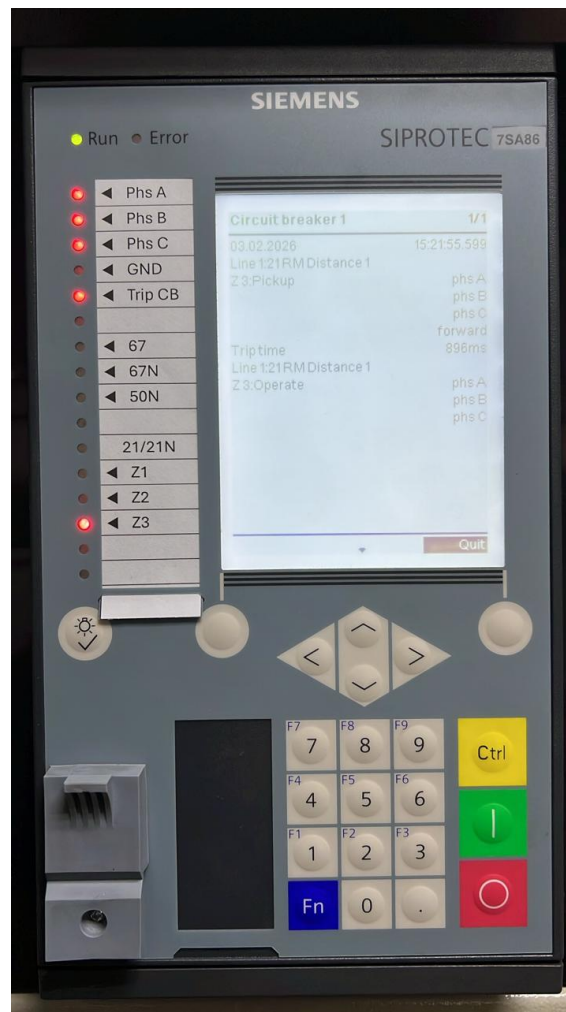
Figura 5.10: Pruebas Z3 Equasol.
