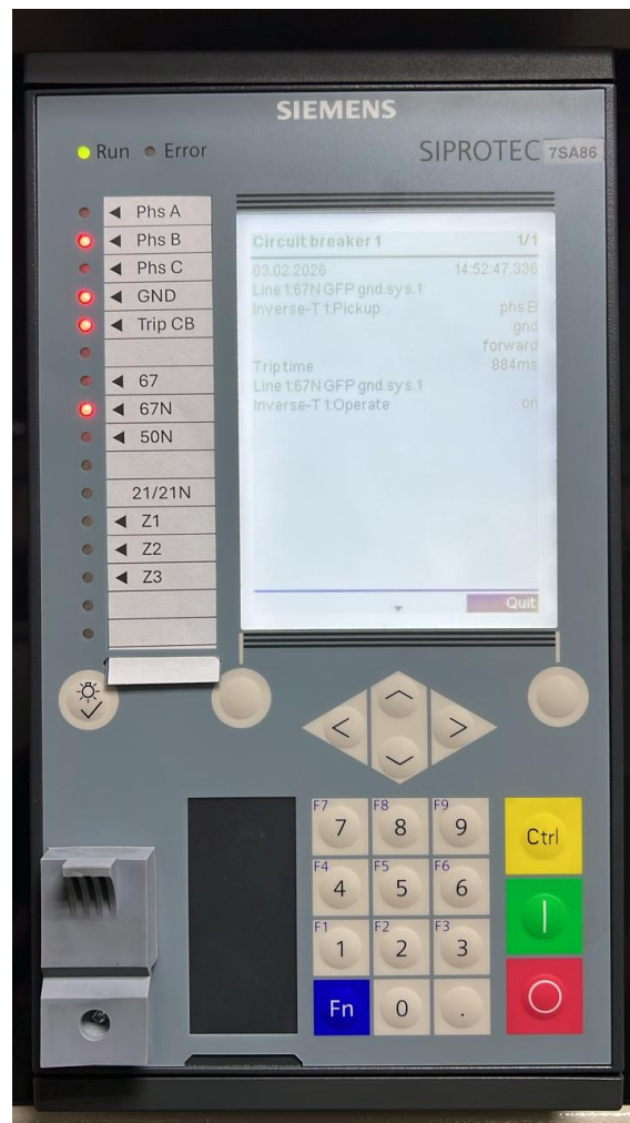
Figura 5.6: Pruebas 67N Equasol
