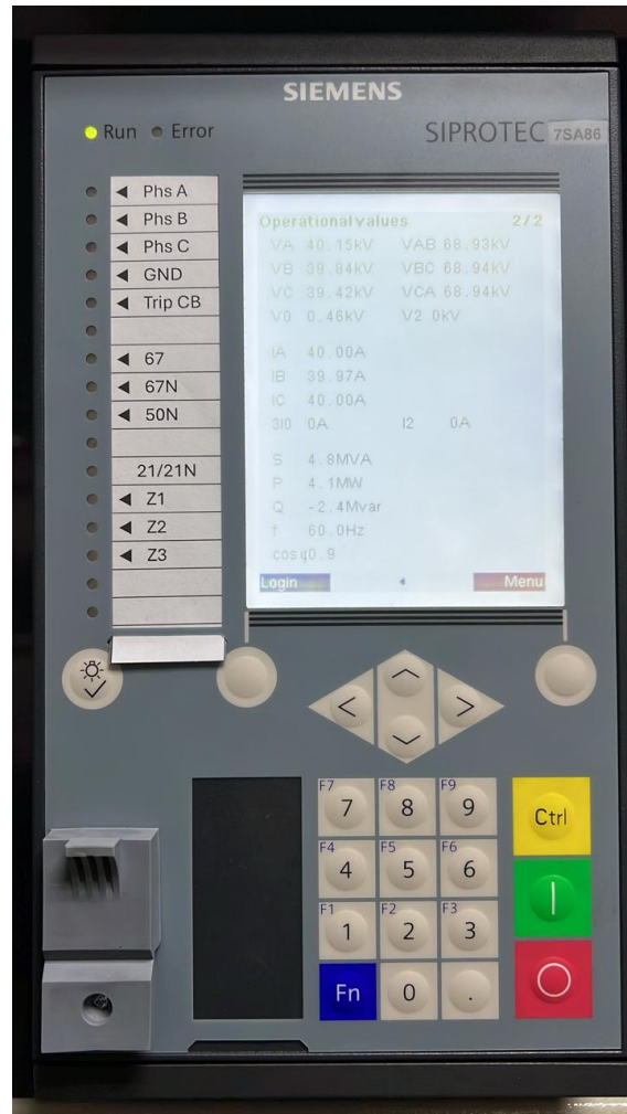
Figura 5.2: Valores nominales de la línea Equasol.
