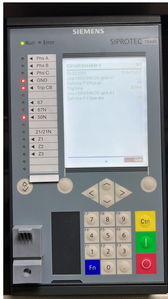
Figura 5.14: Pruebas 50N Equasol.
