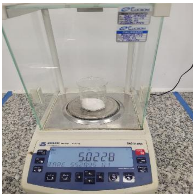
Anexo 1. Proceso del pesaje al agente microbiano degradador de hidrocarburos para la aplicación en el suelo contaminado.
