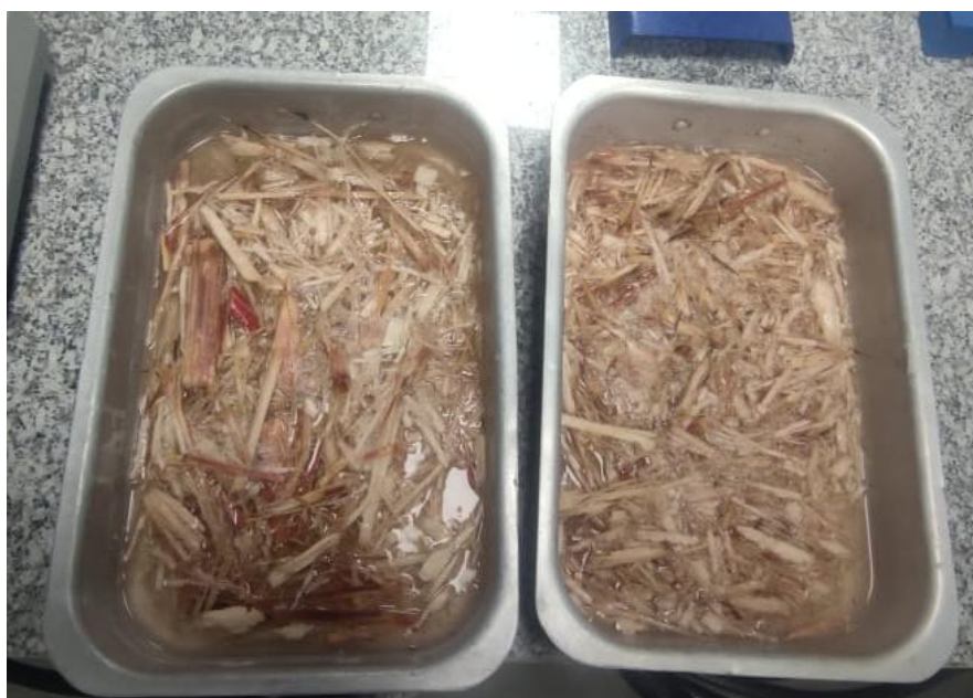
Figura 19. Mezcla final de la disolución de ácido y el bagazo.
