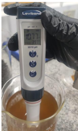
Figura 14. Medición del pH de la muestra.
