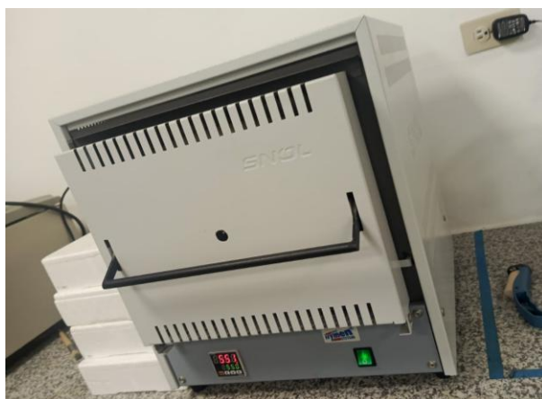
Figura 16. Proceso de secado de la muestra en la mufla.
