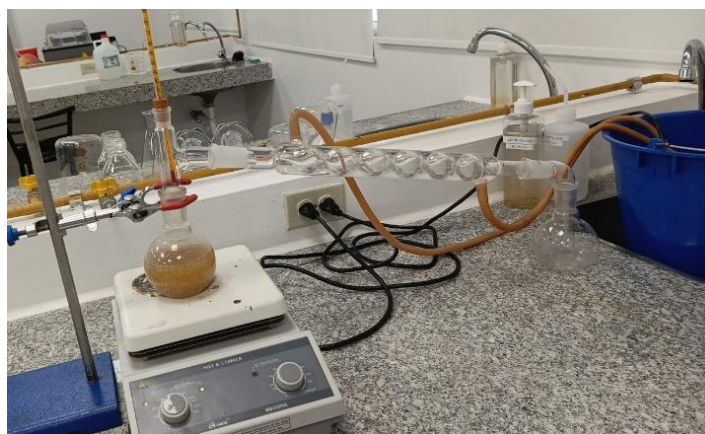
Figura 21. Destilación simple del hidrolizado.
