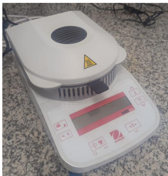
Figura 15. Equipo analizador de humedad OHAUS MB23
