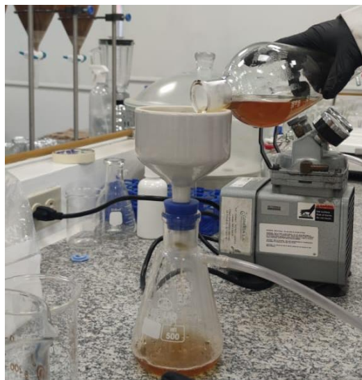
Figura 20. Filtración del hidrolizado ya detoxificado.
