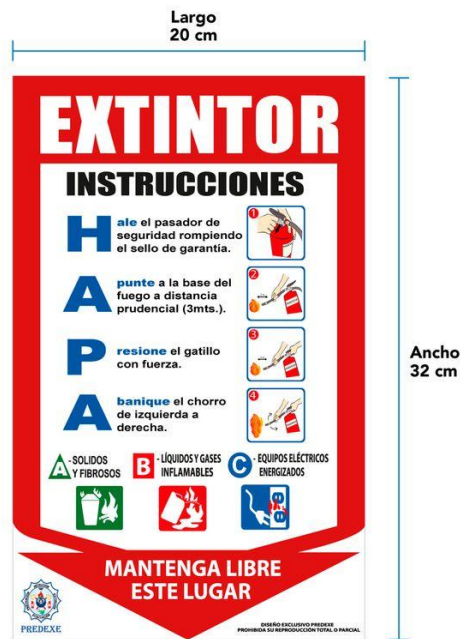
Figura 37. Instrucciones del manejo del extintor
