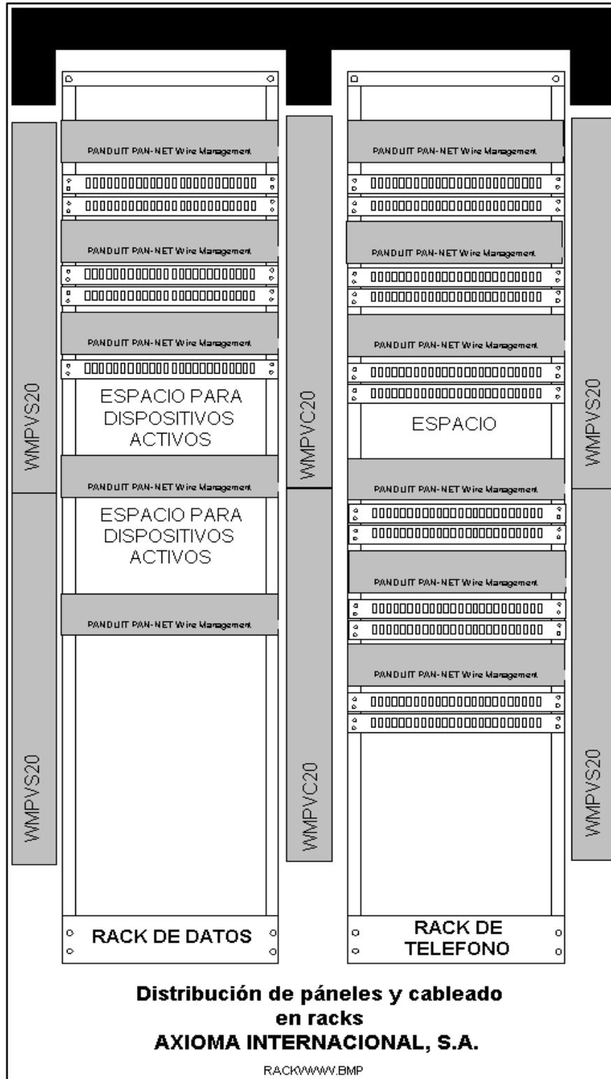
**Figura2.21: Ejemplo de racks combinando teléfono y datos.**
