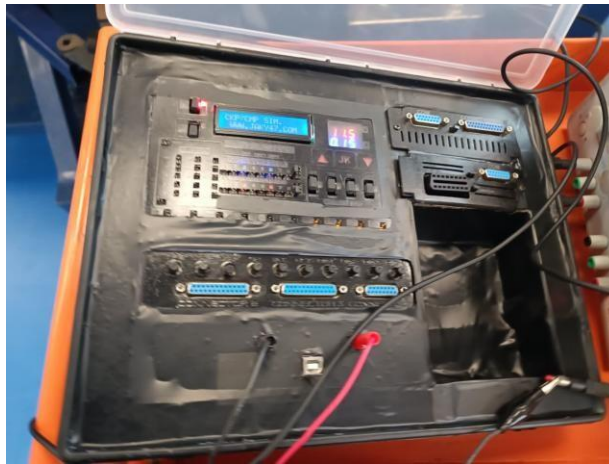
Figura 18. Prueba del sistema de alimentación eléctrica conectado mediante una fuente de poder que entregue 12V
