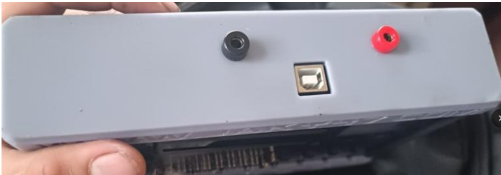
Figura 12. Cara posterior del banco con conectores de alimentación y puerto USB.
