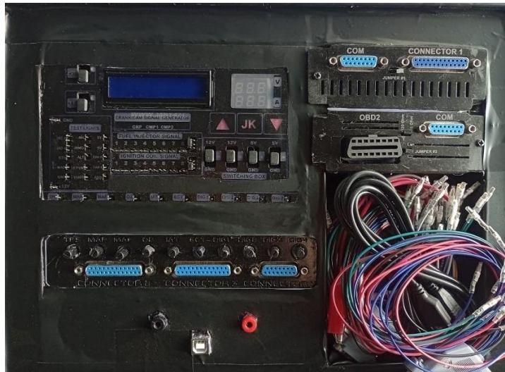
Figura 16. Banco de pruebas implementado en un solo perfil para mejorar la facilidad del uso del equipo.
