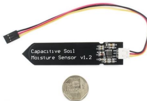
Figura 4. Sensor capacitivo de humedad del suelo versión 1.2 [27].
