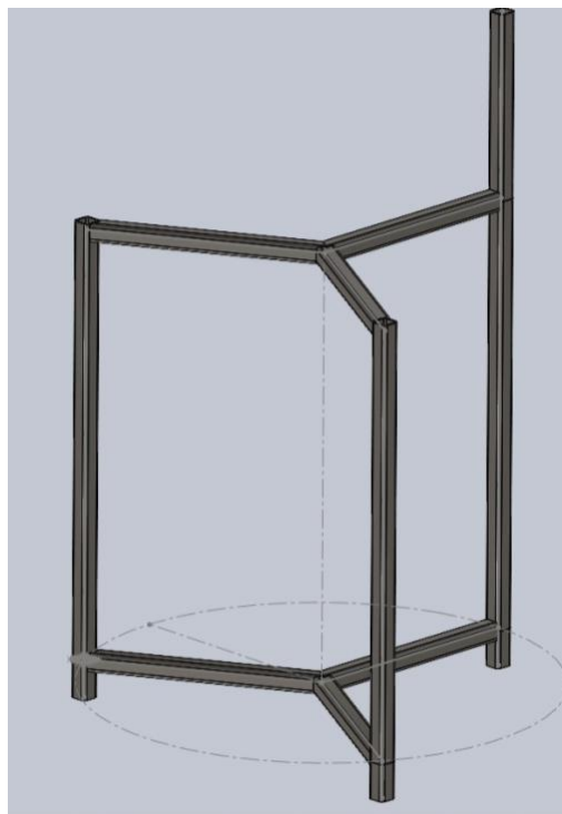
Figura 10. Estructura de acero del lisímetro en SolidWorks.
