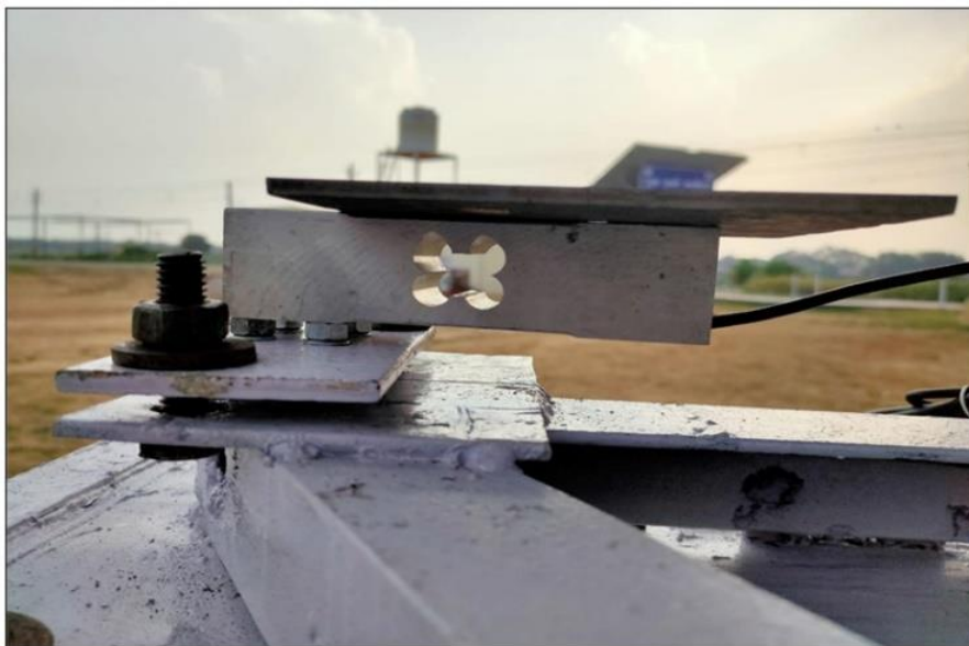
Figura 1. Ejemplo real de un lisímetro de pesaje con sistema de medición mediante galgas extensiométricas [4].
