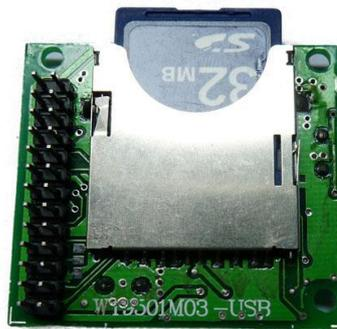
Figura 1.6. Módulo WT9501M03 USB-SD MP3.
