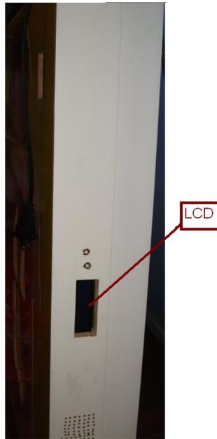
La LCD que muestra el proceso en el cual se encuentra el rompecabezas, teniendo dos estados el primero que muestra: “Colocando...” este es para armar el rompecabezas, mientras que el segundo “Bien!!!” nos indica que se ha acabado de armar el rompecabezas y finaliza la operación.
