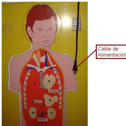
Este es el cable de alimentación, el cual se debe conectar a la alimentación eléctrica, este rompecabezas funciona a voltaje AC 120V y 60Hz.
