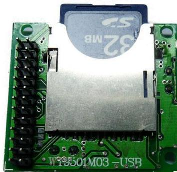
Figura 4.5. Memoria micro-SD insertada en módulo MP3
