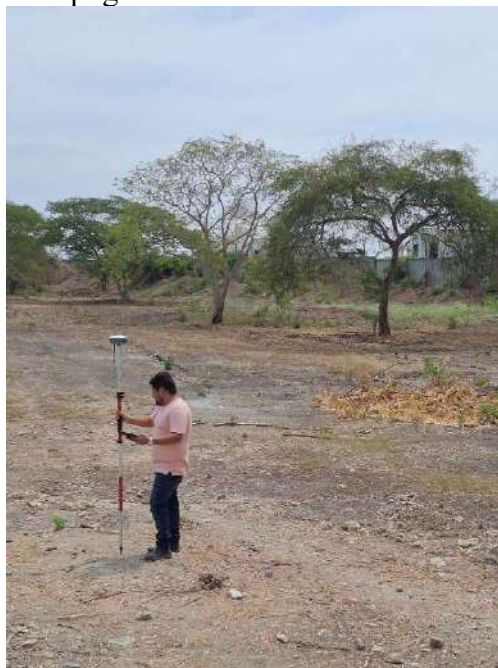
Figura 94: Toma de puntos topográficos
