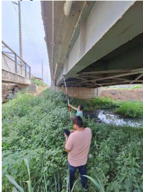
Figura 95: Toma de puntos topográficos
