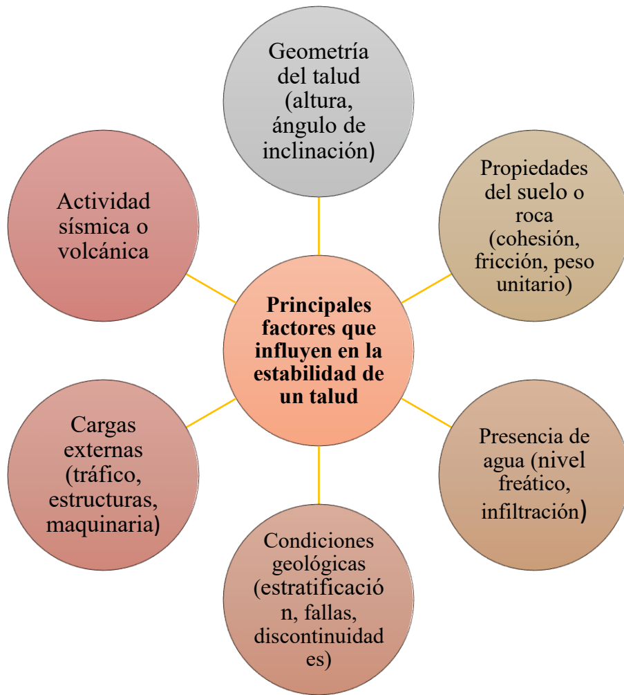
Figura 17 Factores que influyen en la estabilidad de taludes
