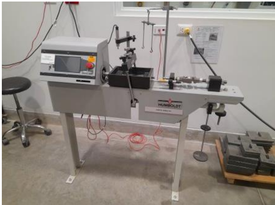
Figura 40 Equipo de corte directo Humboldt HM-5750 utilizado en ensayos de laboratorio
