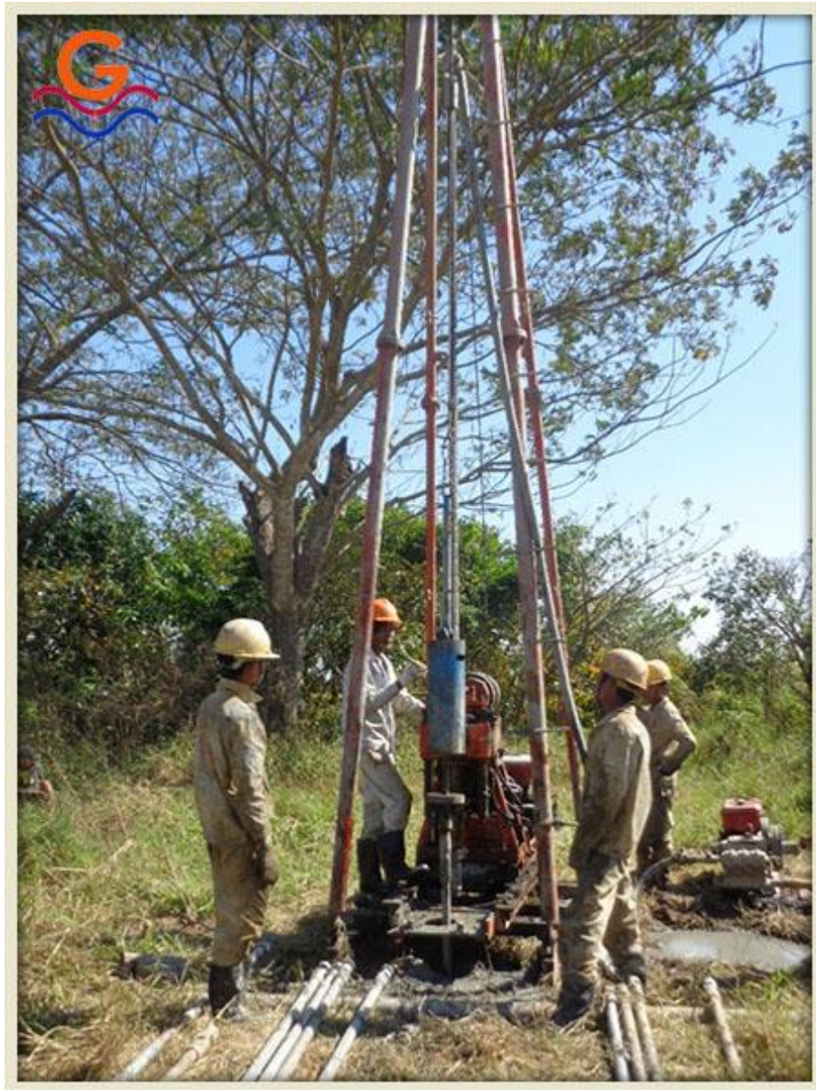
Figura 41 Proceso del ensayo SPT
