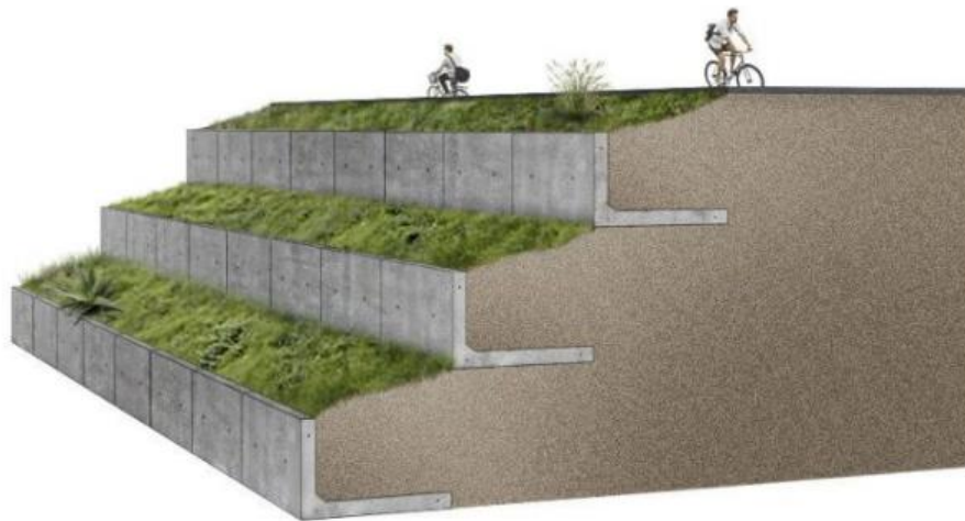
Figura 24 Muro de contención prefabricado tipo MC en el pie de un talud
