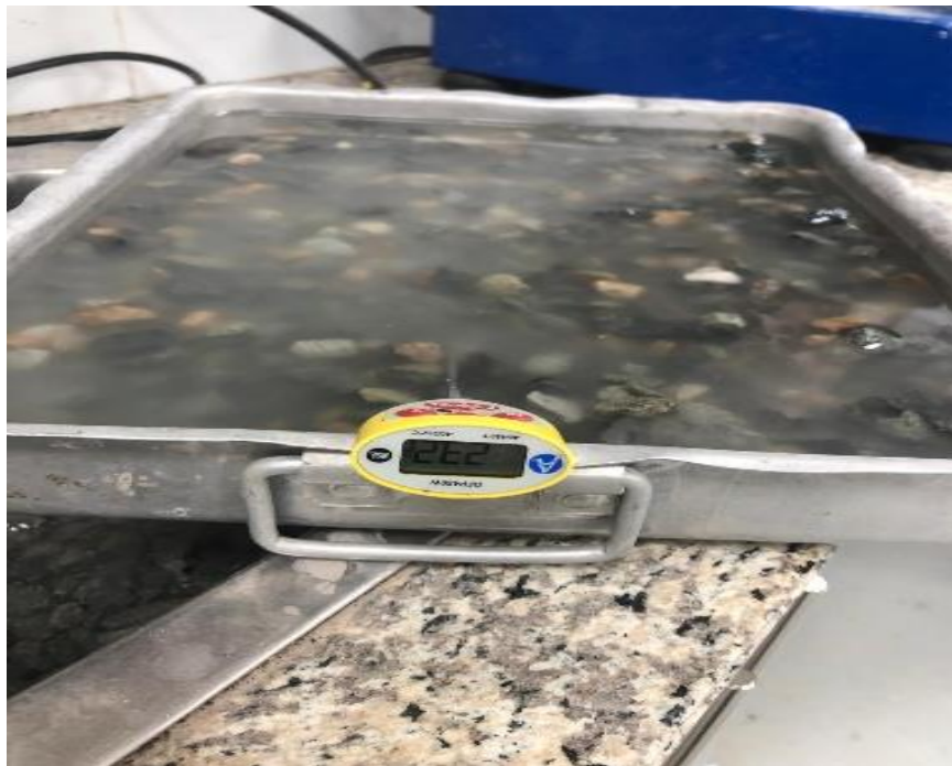
Anexo 8 Toma de temperatura del árido grueso en agua
