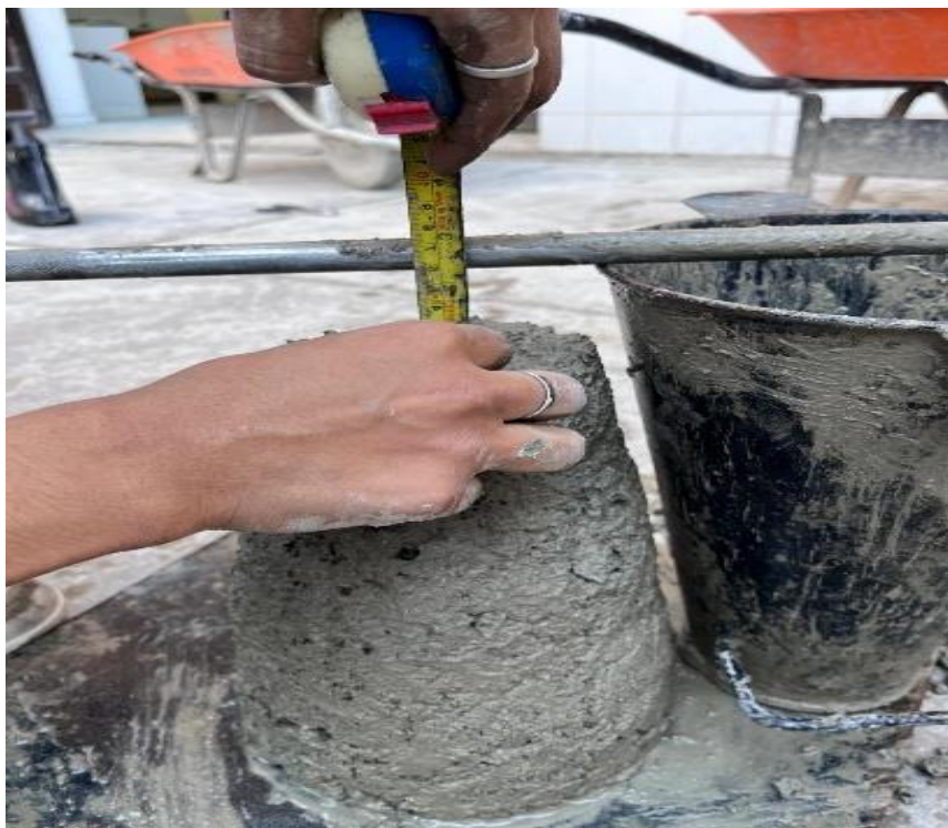
Anexo 14 Fundiciones de probeta de hormigón con polvo de cantera el 30%
