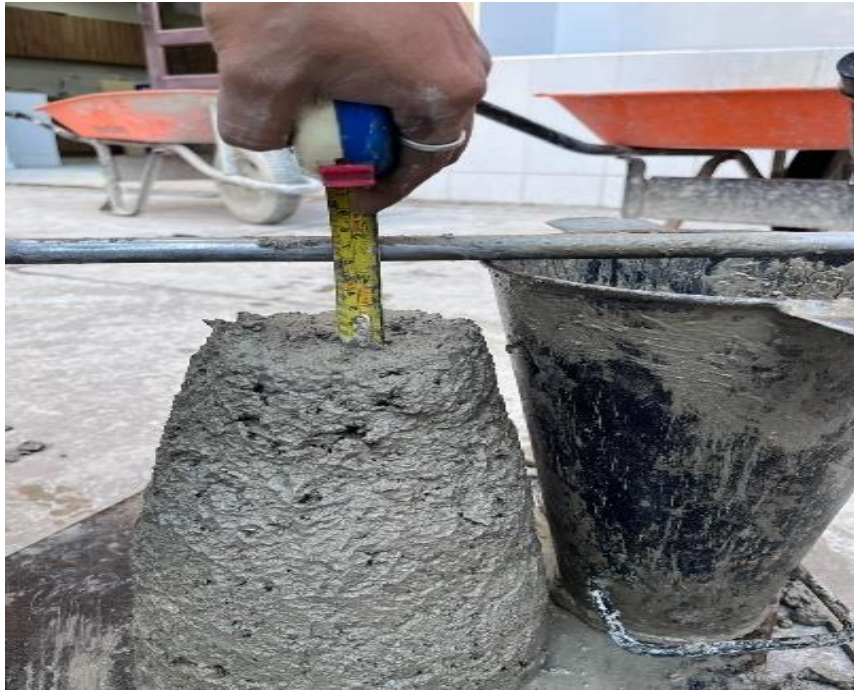
Anexo 14 Fundiciones de probeta de hormigón con polvo de cantera el 30%
