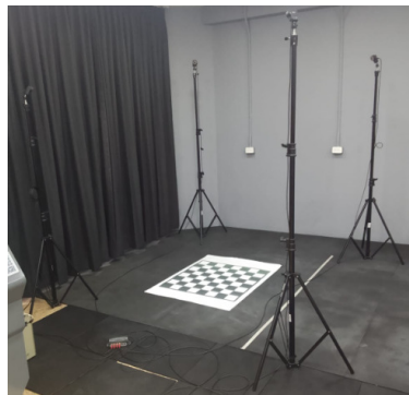
Figura 3-15: Configuración del volumen de captura: cuatro cámaras Flex 3 alrededor del tablero de calibración 8 \times 8 en el piso.
