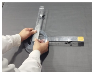
Figura 3-31: Verificación experimental del ángulo de referencia mediante goniómetro manual, configurado a 90^\circ .
