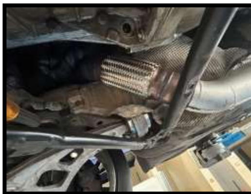
Figura 11. Instalación sistema de escape M52TUB28.
