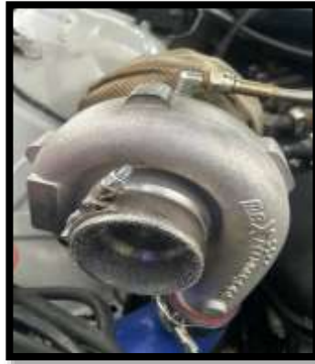
Figura 5. Turbocompresor a instalar en el motor M52TUB28.
