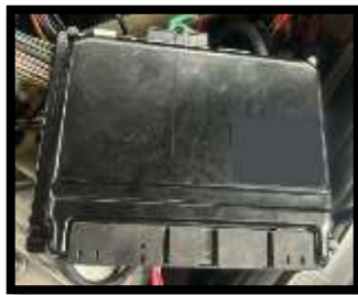
Figura 4. Unidad de control electrónico programable ECU
