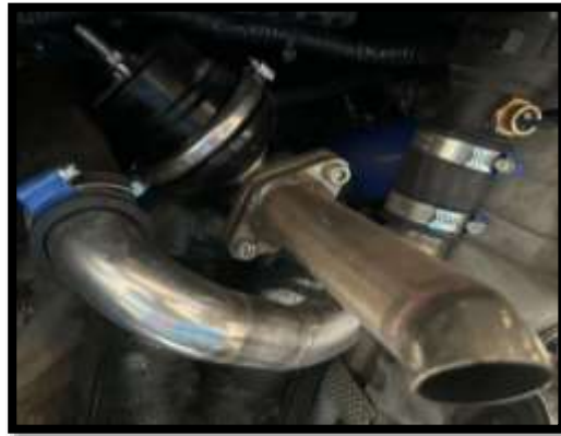
Figura 10. Instalación de Wastegate en M52TUB28.
