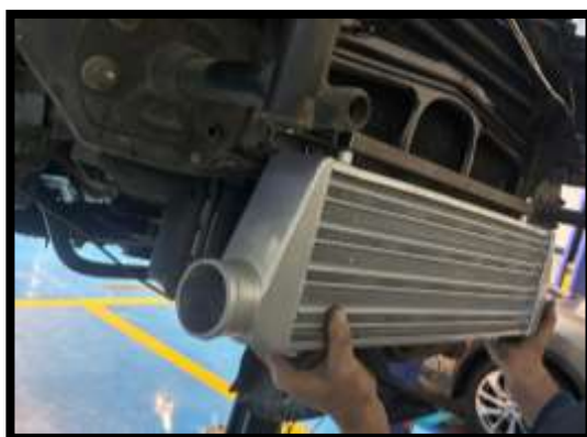
Figura 12. Instalación sistema de enfriamiento.
