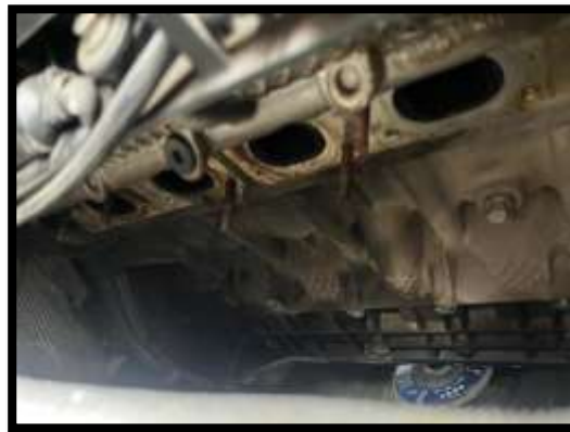
Figura 9. Preparación para Header en M52TUB28.
