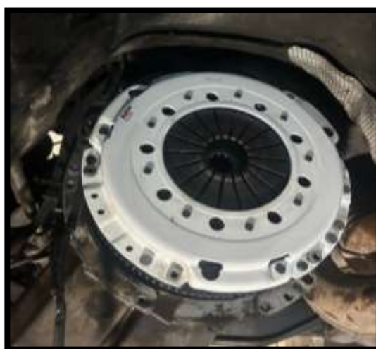
Figura 3. Instalación de embrague Stage 5.
