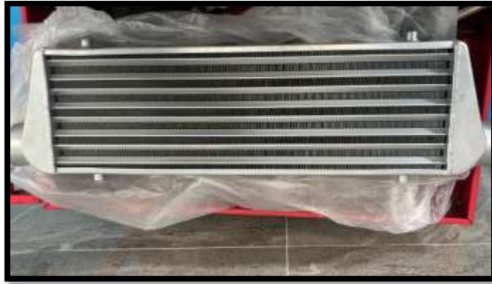
Figura 6. Intercooler a instalar en el motor M52TUB28.
