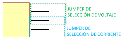
Figura 2.71. Jumper para selección de entrada de voltaje o corriente
