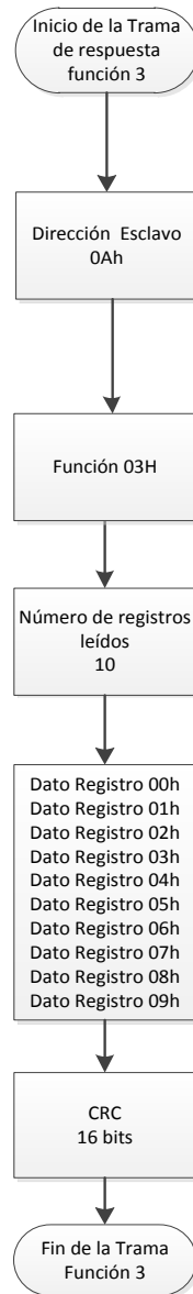
Figura 3.25. Diagrama de flujo respuesta del esclavo dirección 10. 10 registros a partir de la dirección 00h
