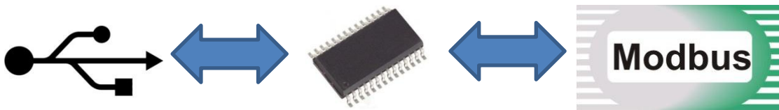
Figura 3.76. Diagrama básico de enlace entre PIC18F2550 vía USB y Modbus
