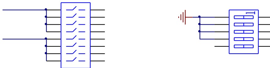
Figura 2.24. Dip Switch utilizados para selección de comunicación y direccionamiento
