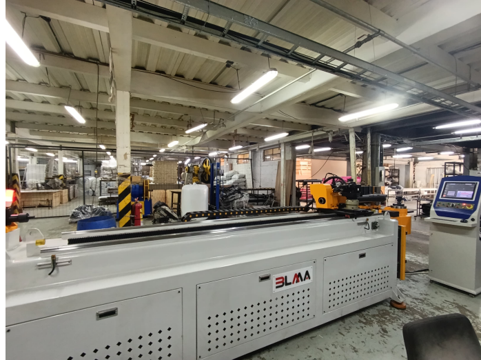
Figura 25. Maquinaria curvadora CNC previo a iniciar operaciones dentro de la estación de curvado.
