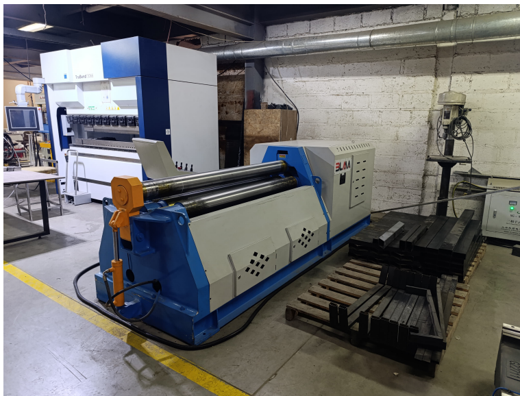
Figura 23. Vista general de la estación de rolado y disposición del área de trabajo con el material a trabajar.
