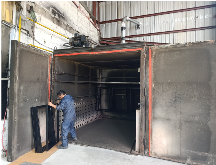
Figura 34. Horno de curado térmico para recubrimiento en polvo y retiro de piezas.
