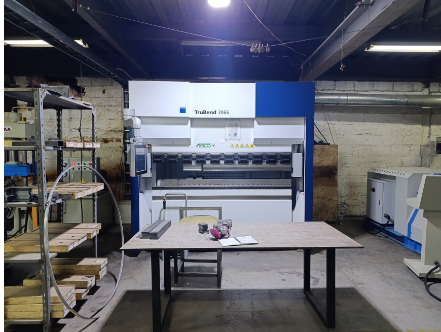
Figura 21. Vista general de la estación de doblado conjuntamente con la maquinaria especializada en este procedimiento.
