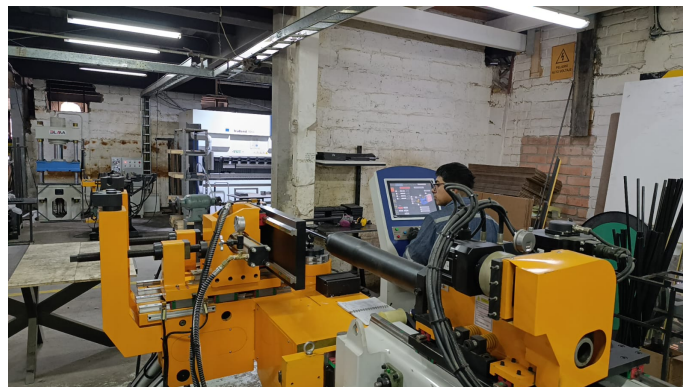
Figura 26. Operario ejecutando el proceso de curvado en maquinaria CNC.
