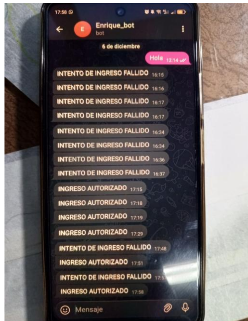
Figura 21: Envío de notificación a Telegram indicando ingreso autorizado o fallido.
